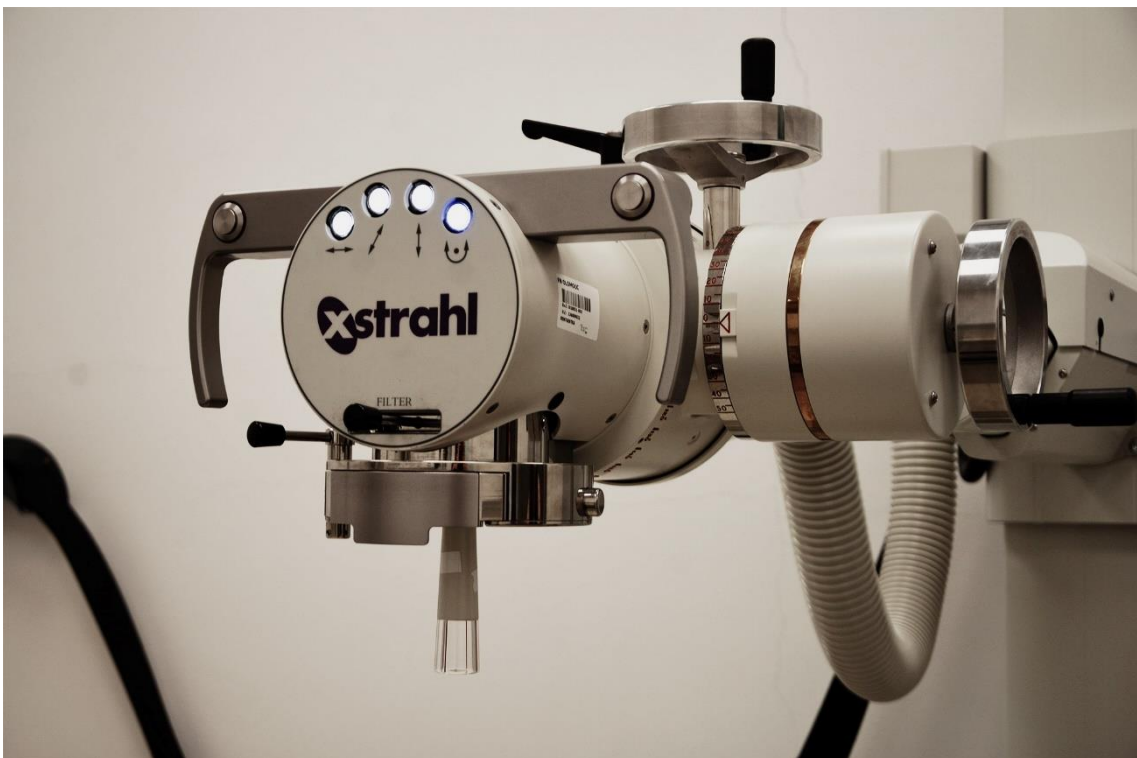
Obrázek 6 – detailní záběr na rentgenový ozařovač
