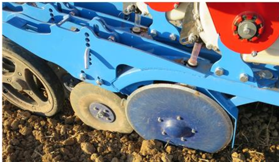
Obr. č. 5: Secí disky s přitlačným kolem
