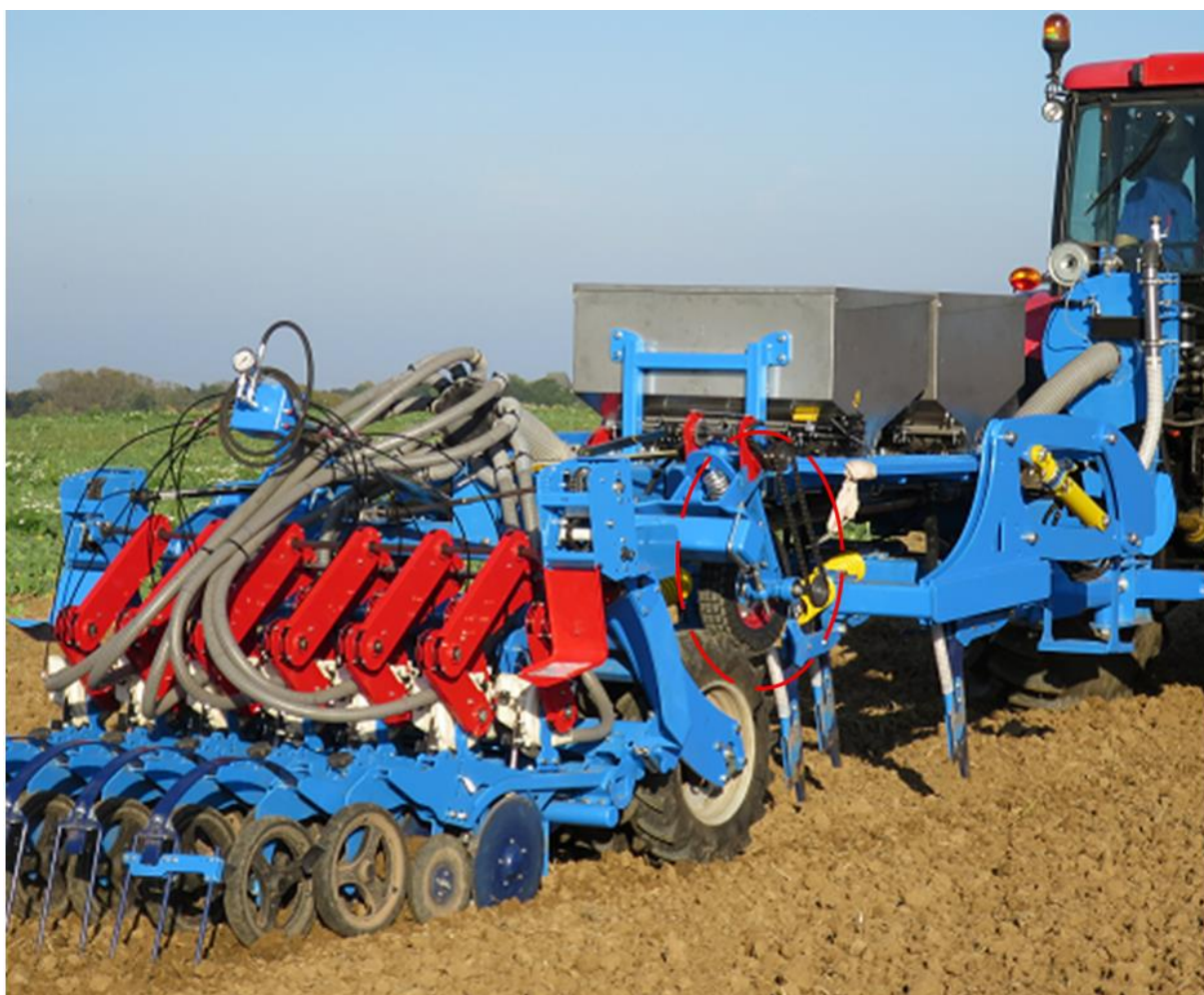
Obr. č. 4: Stroj FARMET pro přesné setí zejména v minimalizacích
