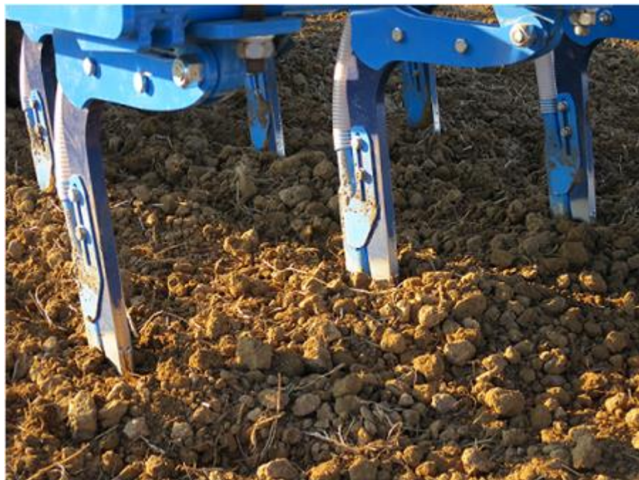
Obr. č. 6: Radličky zakrojené v půdě s „husími krky“ pro hnojivo
