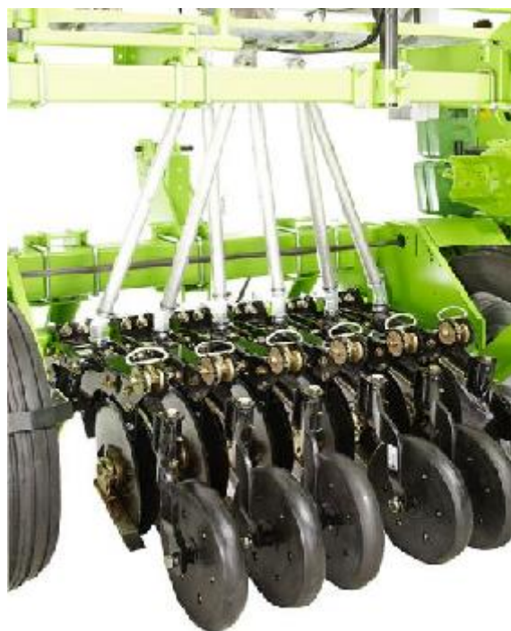
Obr. č. 3: Diskové secí botky a přítlačná kola
