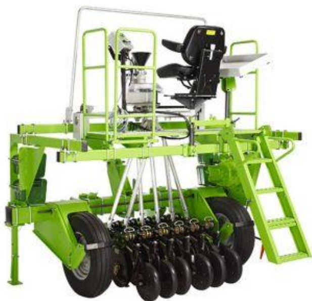
Obr. č. 3: Diskové secí botky a přítlačná kola
