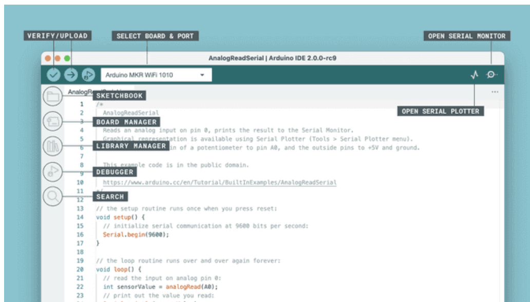
Obrázek 2.1: Ukázka hlavního pohledu v Arduino IDE 2 popisující i jednotlivé části uživatelského rozhraní 1
