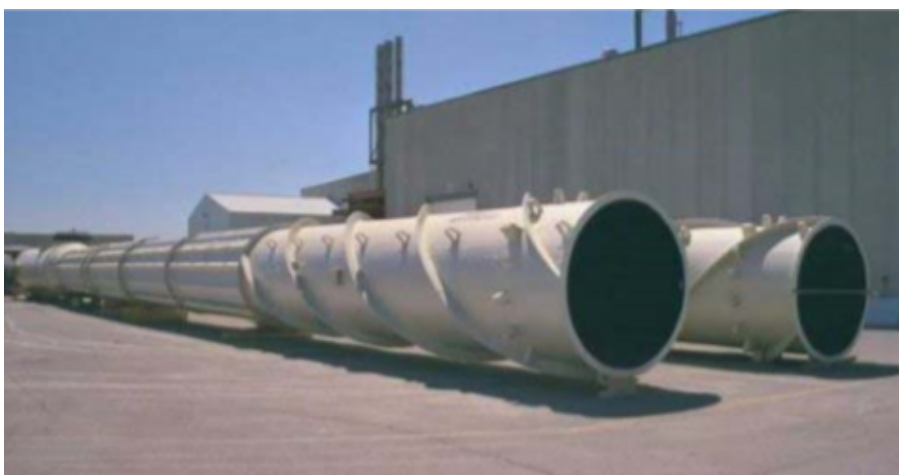
Obr. 2.8: Výčnělky na velkých průmyslových komínech [6].
