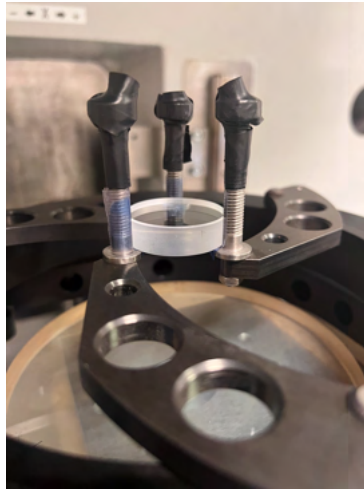
Obrázek 4.20: Detail na umístění vzorku v interferometru AWA
