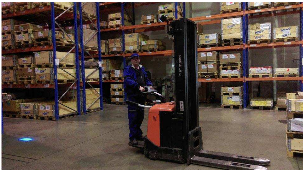
Obrázek 10 Pracovník na VZV při couvání (po levé straně světelná výstraha couvajícího vozíku)
