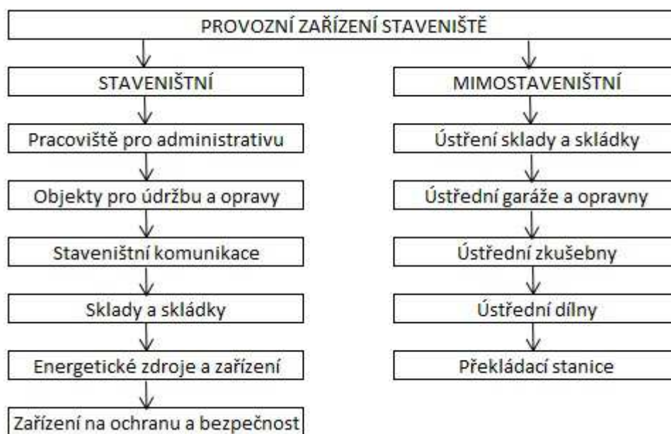
Obrázek 3- Členění provozního zařízení staveniště
