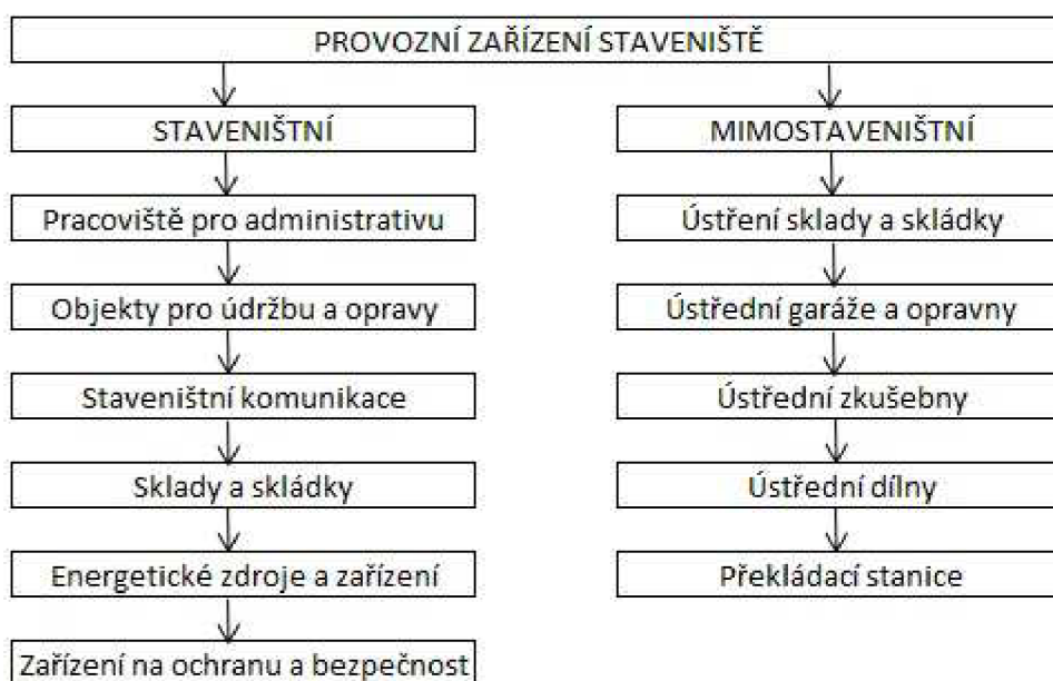
Obrázek 3- Členění provozního zařízení staveniště
