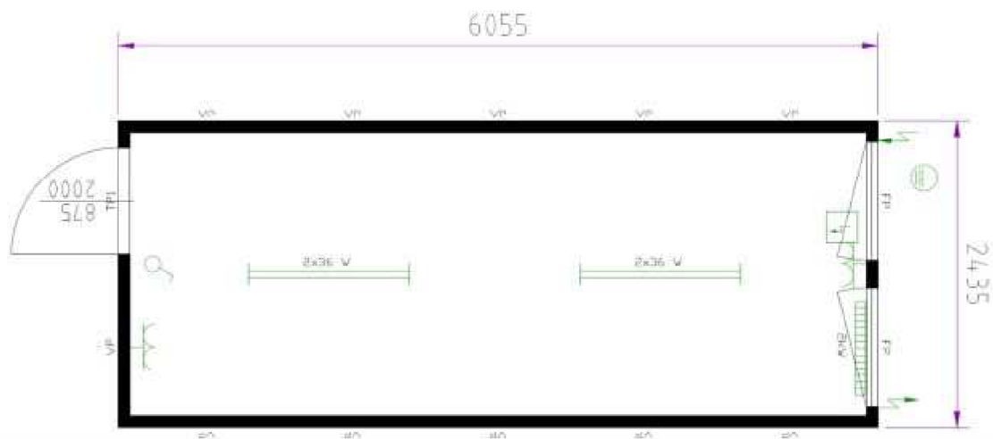
Obrázek 21 – Šatna pracovníci a stavbyvedoucí - kontejner COMA OB6-2
