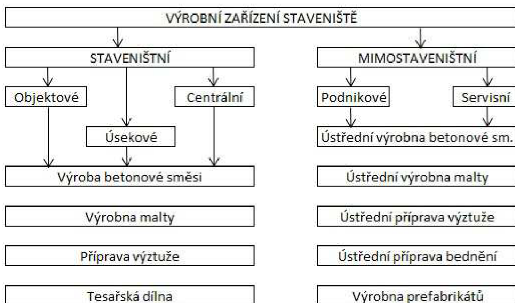
Obrázek 4 – Členění výrobního zařízení staveniště
