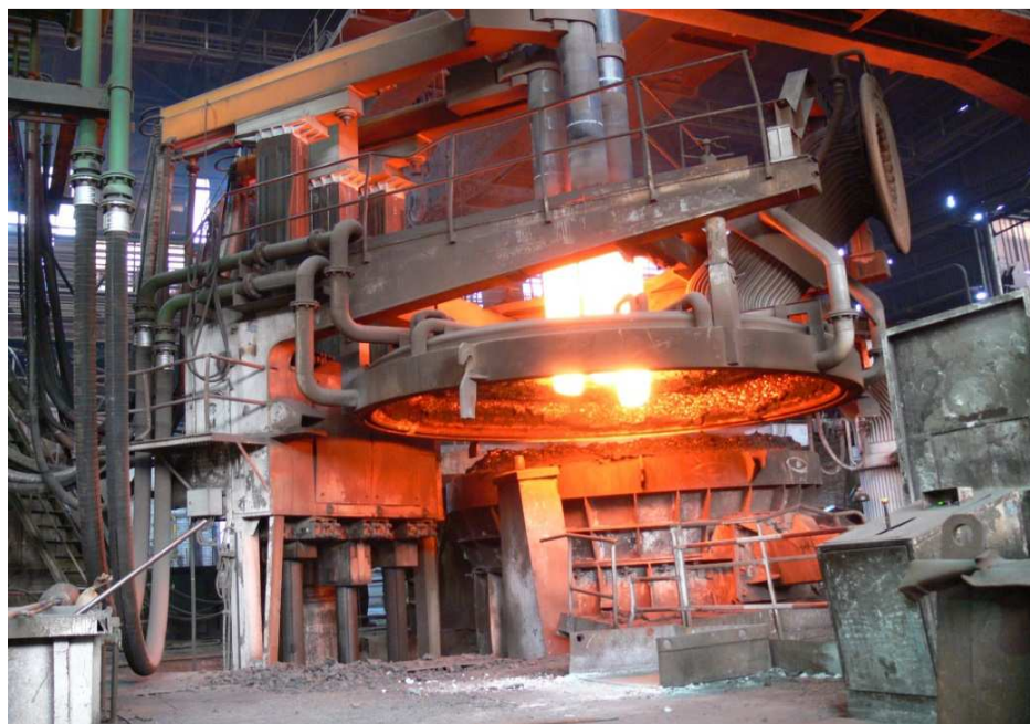
Obr. 18 Elektrická oblouková pec s hmotností vsázky 25 tun [7]
