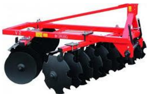
Obr. 15 Uspořádání talířů do "V"
