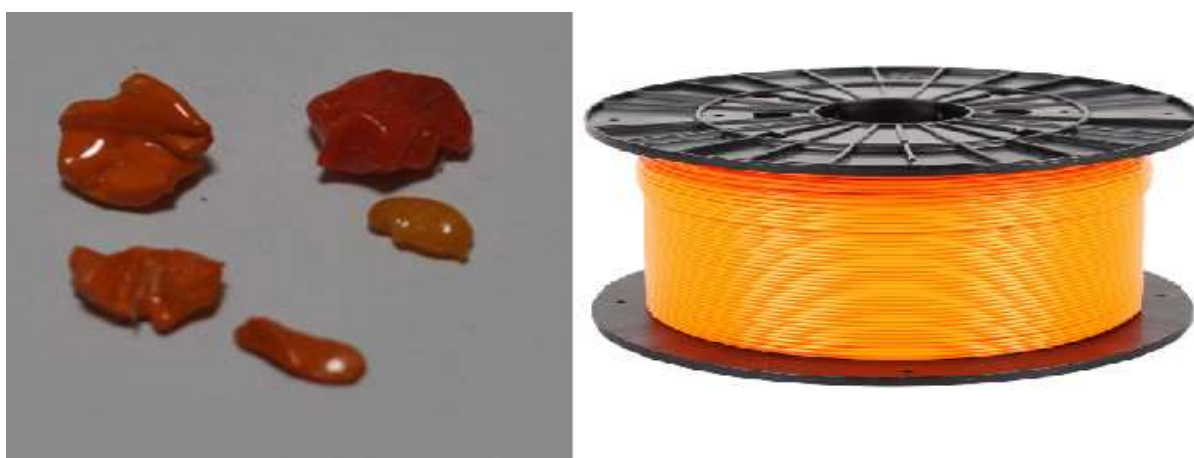
Obrázek 15: Skupina 2 a možný zdroj kontaminace. Vlevo: příklad vzorků spadajících pod skupinu 2 [10]; vpravo: struna pro 3D tisk z PLA [74].
