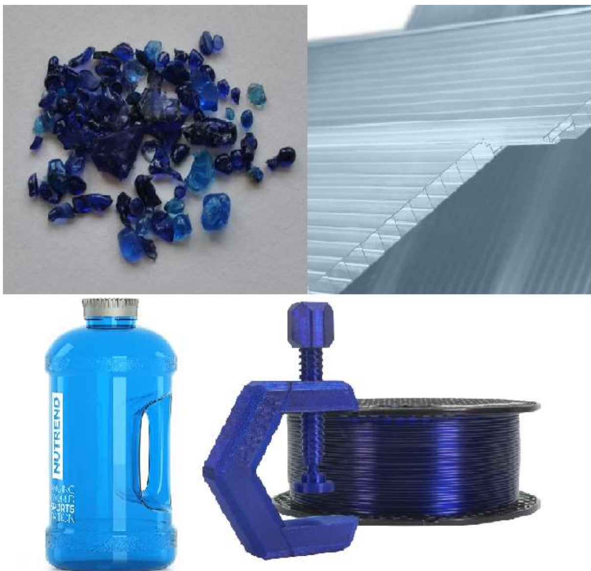
Obrázek 19: Skupina 5 a možné zdroje kontaminace. Nahoře vlevo: vzorky z primární skupiny 20 identifikovány jako PETG [10]; nahoře vpravo: deska z PC [82]; dole vlevo: PETG „fitness“ láhev [83]; dole vpravo: PETG vlákno pro 3D tisk [84].
