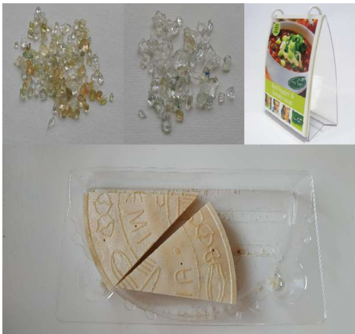
Obrázek 22: Skupina 6 a možné zdroje kontaminace. Horní řada vlevo: PS a HIPS kontaminanty (primární skupina 30) [10]; horní řada uprostřed: PETG vzorky kontaminantů (primární skupina 31) [10]; horní řada vpravo: stojan na jídelní lístek z PETG vylisku [85]; spodní řada: obalový materiál z PS (táček na lázeňské oplátky).
