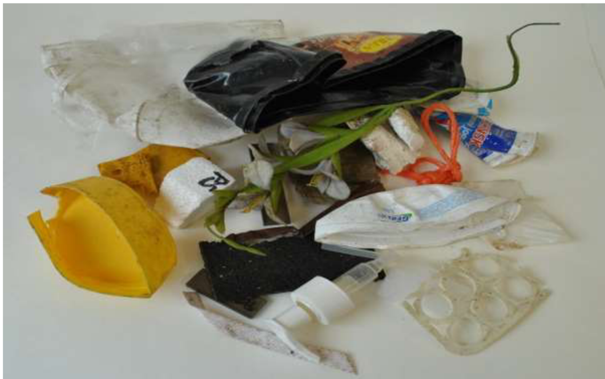
Obrázek 11: Příklady původu kontaminace jinými plasty [10].
