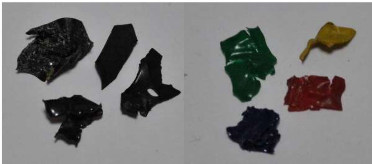
Obrázek 31: Příklady kontaminantů ze skupiny 12, které byly identifikovány jako PA, PET i PVC (vlevo primární skupina 49; vpravo primární skupina 50) [10].
