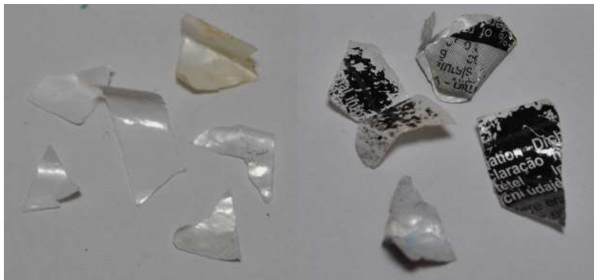
Obrázek 29: Příklady kontaminantů za skupiny 10 (identifikovány jako PET: vlevo primární skupina 43 [10]; vpravo: primární skupina 44) [10].
