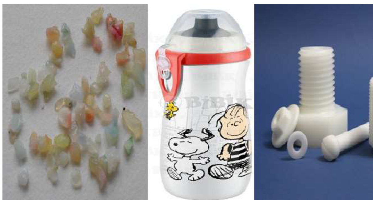
Obrázek 17: Skupina 3 a možné zdroje kontaminace. Vlevo: vzorky PP, POM, ABS, ASA, PS a HIPS z primární skupiny 15 [10]; uprostřed: dětská láhev z PP [78]; vpravo: součástky z POM [79].
