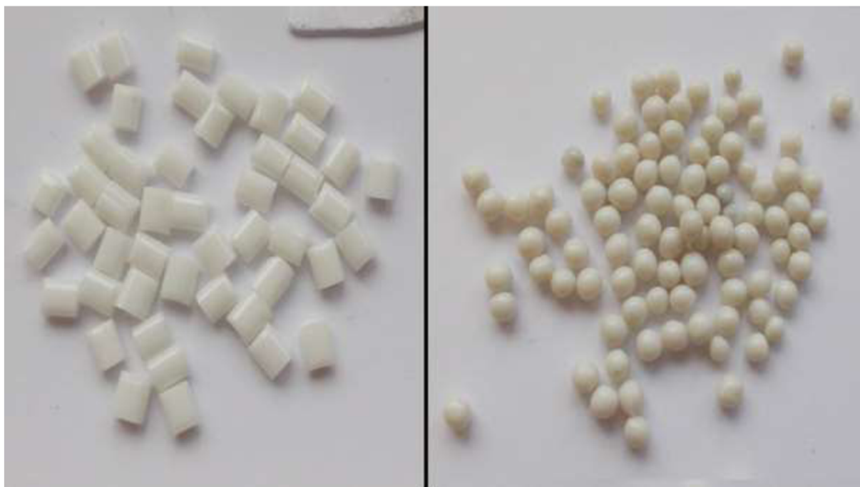
Obrázek 3: Srovnání pelet panenského PET (vlevo) a regranulátu PET (vpravo) [10].
