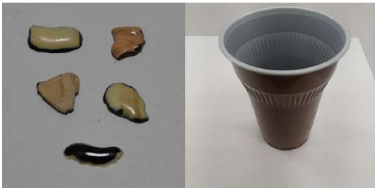
Obrázek 18: Skupina 4 a možný zdroj kontaminace. Vlevo: vzorky ze skupiny 4 (respektive primární skupina 16) [10]; vpravo: PS kelímek.
