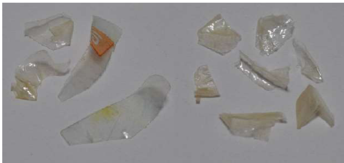
Obrázek 26: Příklad vzorků kontaminantů ze skupiny 8: vlevo směs PET a PA (primární skupina 37) [10]; vpravo pouze PA nečistoty (primární skupina 38) [10].
