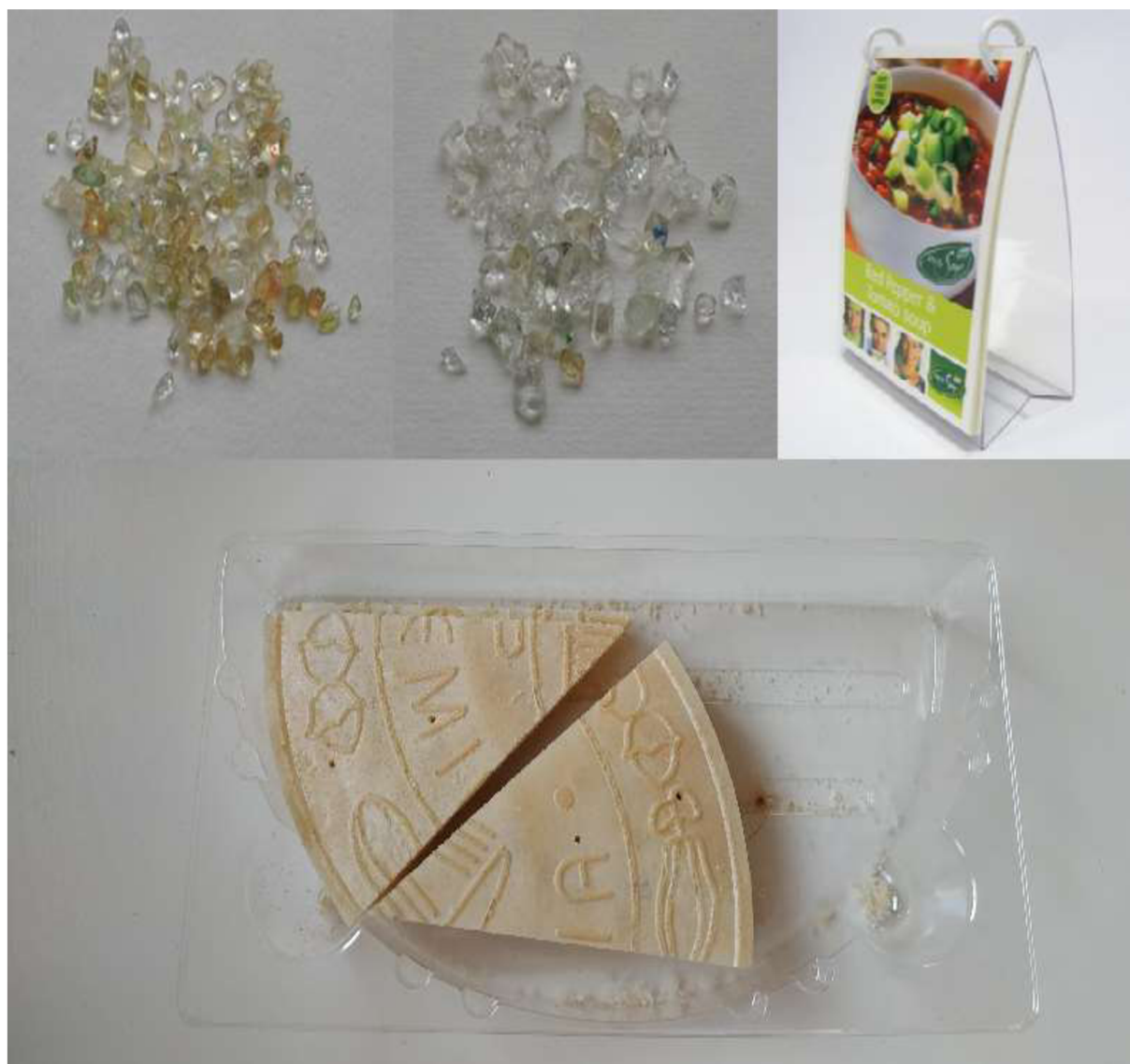
Obrázek 22: Skupina 6 a možné zdroje kontaminace. Horní řada vlevo: PS a HIPS kontaminanty (primární skupina 30) [10]; horní řada uprostřed: PETG vzorky kontaminantů (primární skupina 31) [10]; horní řada vpravo: stojan na jídelní lístek z PETG vylisku [85]; spodní řada: obalový materiál z PS (táček na lázeňské oplatky).
