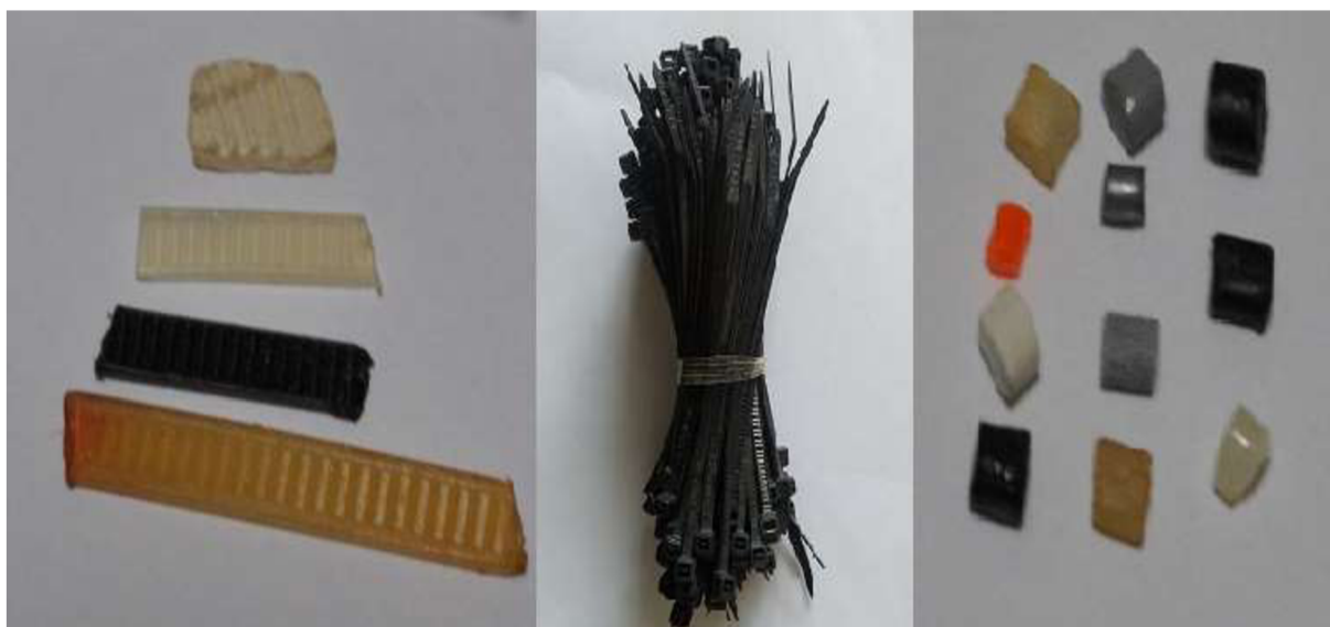
Obrázek 32: Skupina 13 a možný zdroj kontaminace. Vlevo: příklad kontaminace z PA vázacích pásek (primární skupina 53) [10]; uprostřed: vázací pásky jako příklad možného zdroje kontaminace; vpravo: kontaminace v podobě pelet z PA s neznámým původem (primární skupina 54) [10].
