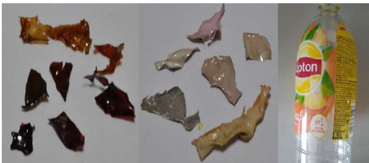
Obrázek 23: Skupina 7 a možný zdroj kontaminace. Vlevo a uprostřed: PVC vzorky kontaminantů (z primárních skupin 32 a 34) [10]; vpravo: rukávek na lahvi pravděpodobně vyrobený z PVC.
