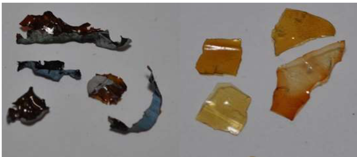
Obrázek 25: Vzorky PET+PE z primární skupiny 33 (vlevo) a kontaminantů z PET a PVC z primární skupiny 35 (vpravo) [10].
