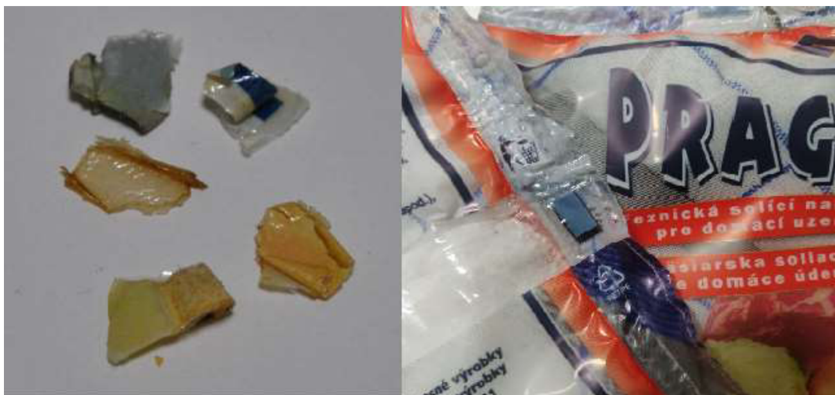
Obrázek 28: Skupina 9 a kontaminace. Vlevo: příklad vzorků PET a PET+PE z primární skupiny 40 [10]; vpravo: PET/PE folie určená jako obal pro solící směs.
