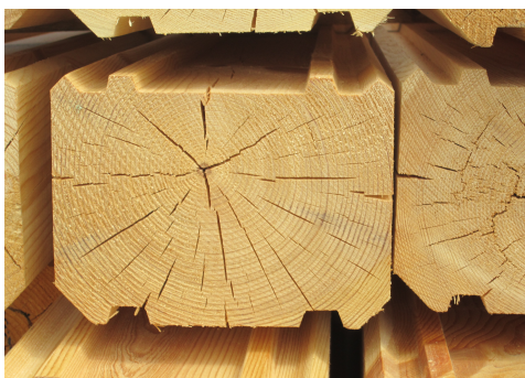
Obrázek 20. Profilovaný hranol ( Profilirovanny brus: vybiraem pravilno , 2017)
