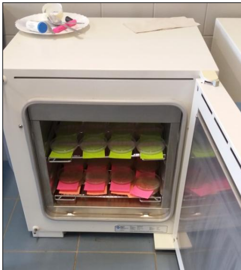
Obrázek 17: Termostat a pomůcky pro založení testu (Walachová, 2016)
