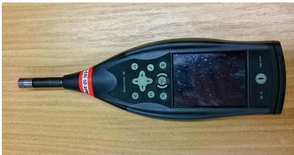
Obr. 3.17: Ruční analyzátor Brüel & Kjær typ 2270
