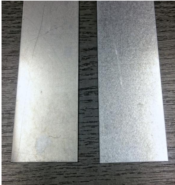
Obr. 3.4: Připravené vzorky, zleva ZM a HDG
