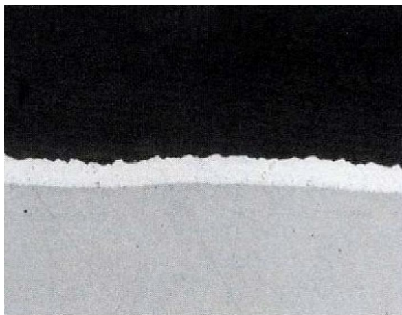
Obr. 2.4: Podélný rez elektrolyticky pozinkovaného povrchu, zvětšeno 1000x [2]
