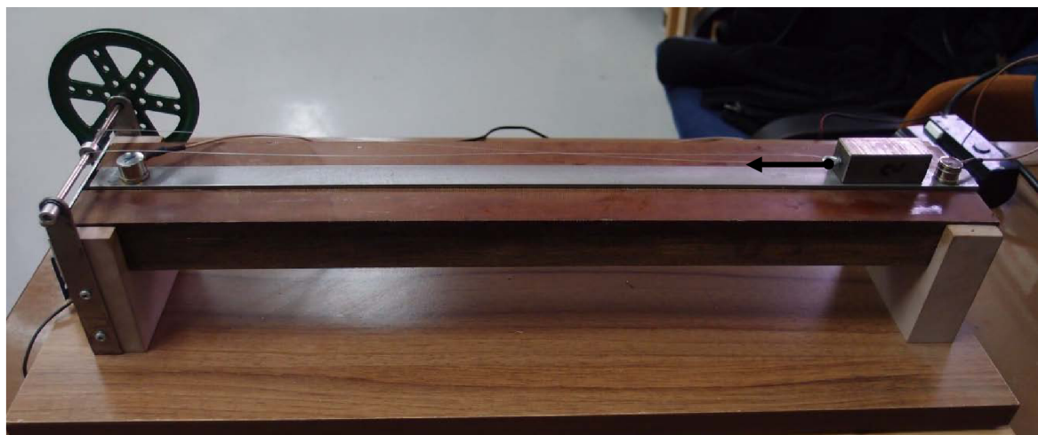
Obr. 15 Uchycení kovového vzorku v přípravku.
