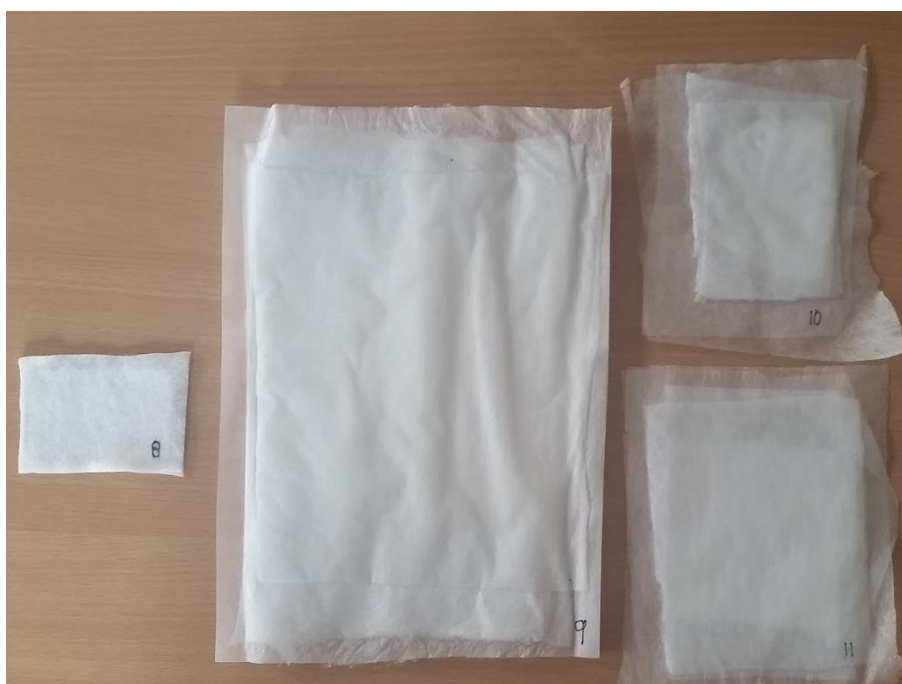
Obrázek 28: Laminované vzorky při teplotě T = 130\text{ °C} ; 2,3 m/min; 14 sec: vzorek 8; Laminované vzorky při teplotě T = 120\text{ °C} ; 2,3 m/min; 14 sec: vzorek 9; Laminované vzorky při teplotě T = 113\text{ °C} ; 2,3 m/min; 14 sec: vzorky 10-11
