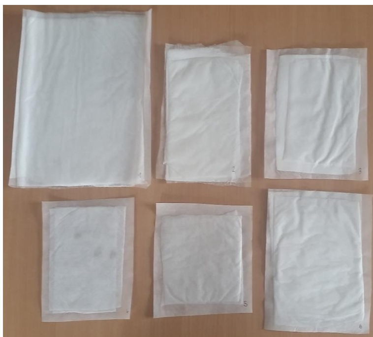
Obrázek 26: Laminované vzorky při teplotě T = 130\text{ °C} ; 2,3 m/min; 14 sec: vzorky 1-6
