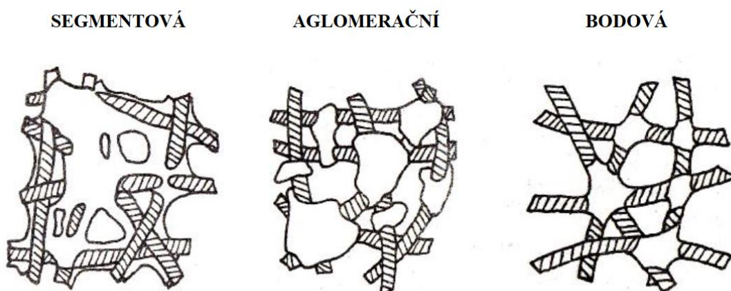
Obrázek 12: Mikrostruktura spoje termického a chemického pojení [23]
