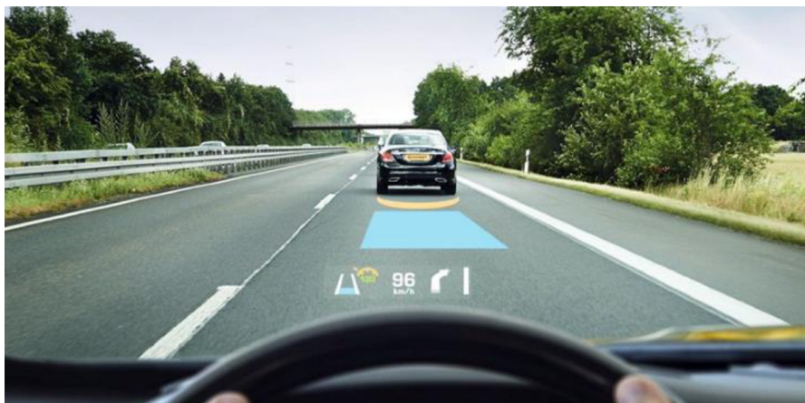
Obrázok 2.1: Head-up displej v automobile
