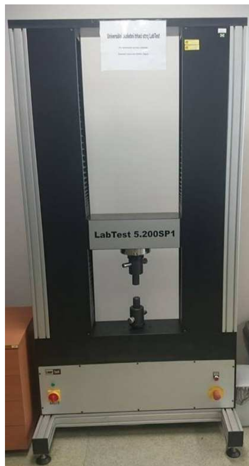
Obrázek 39: Zkušební univerzální trhací stroj LabTest 5.200SP1
