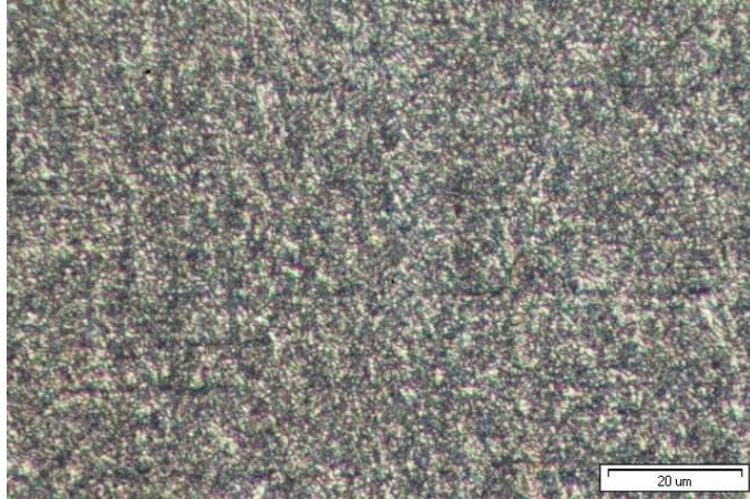
Obrázek 35: Snímek kalené a následně popouštěné oceli
