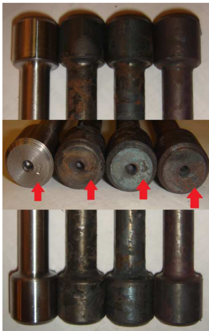
Obrázek 28: Označení zkušebních tyčí na tahovou zkoušku
