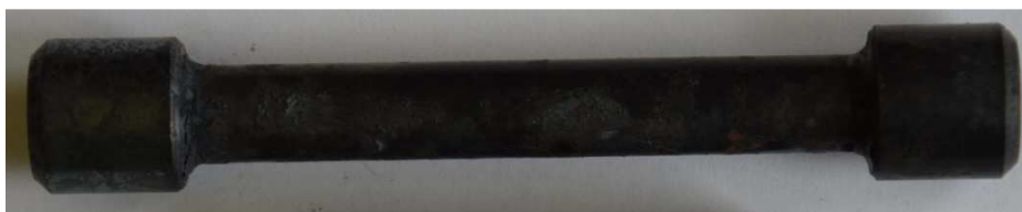
Obrázek 32: Zkušební těleso normalizačně žíhání
