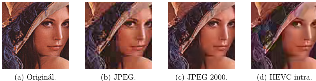
Obrázek 3.1: Porovnání artefaktů kompresních metod při nízkých datových tocích.
