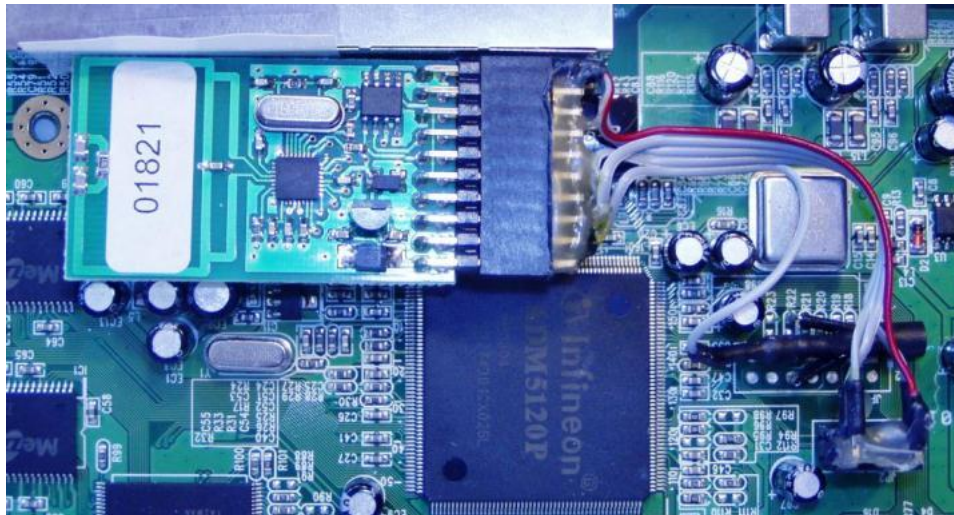
Obrázek 4.4: Detailní pohled na připojení UM k routeru
