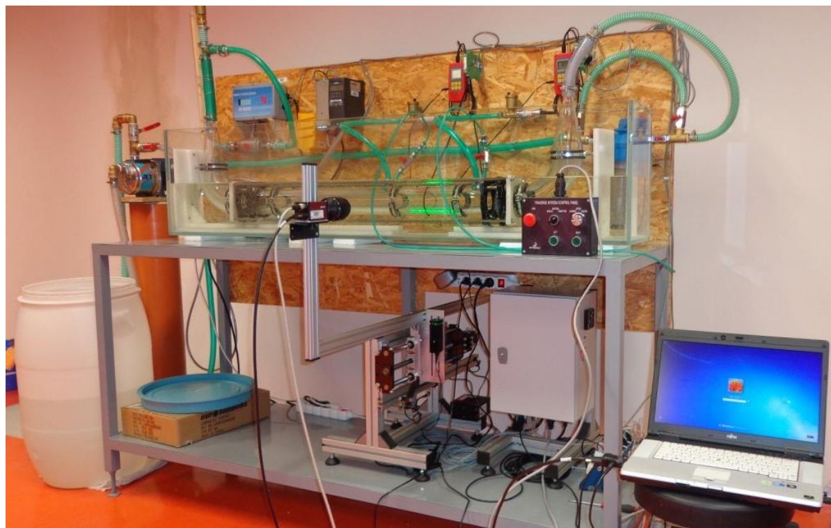
Obrázek 32: Fotografie vodní filtrační aparatury v laboratoři s filtračním kanálem první generace.
