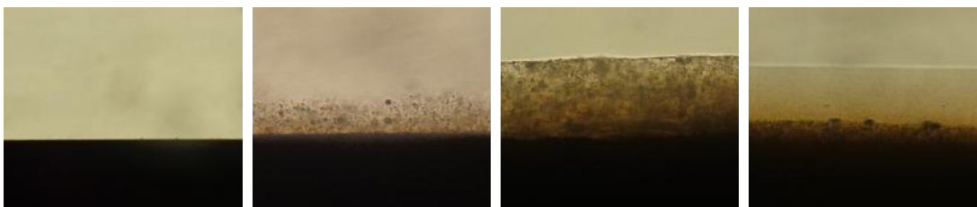
Obrázek 70: Ukázka snímků filtračního koláče na membráně při filtraci bentonitu.
