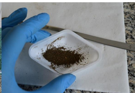
Obrázek 7 - Navážka vzorku do platové lodičky (zdroj: autor)
