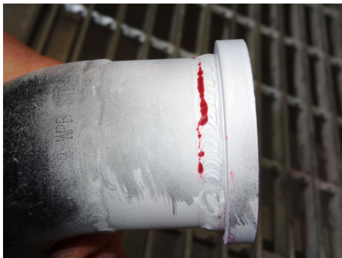
Obr. 30 Metoda barevné indikace [47].
