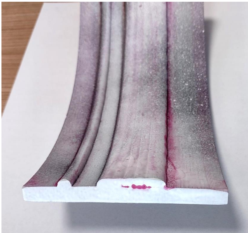
Obr. 42 Kapilární zkouška na řezu trubky s návarem 4.
