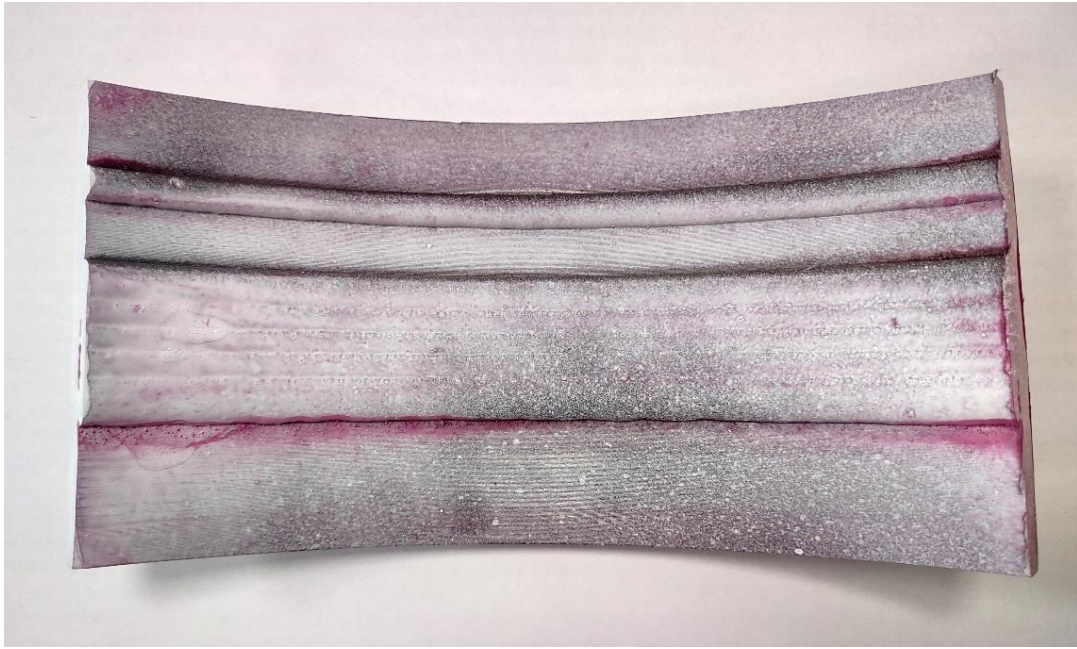
Obr. 41 Kapilární zkouška návaru 4.
