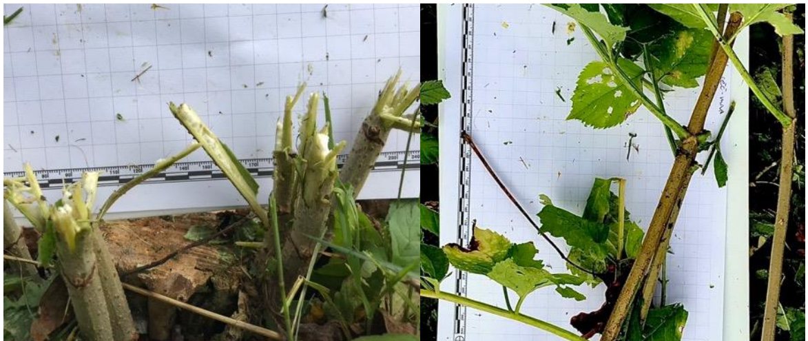
Obrázek 24 Jednoletý obrost náletové dřeviny, posečeno vertikálním mulčovačem se sklopnými noži
