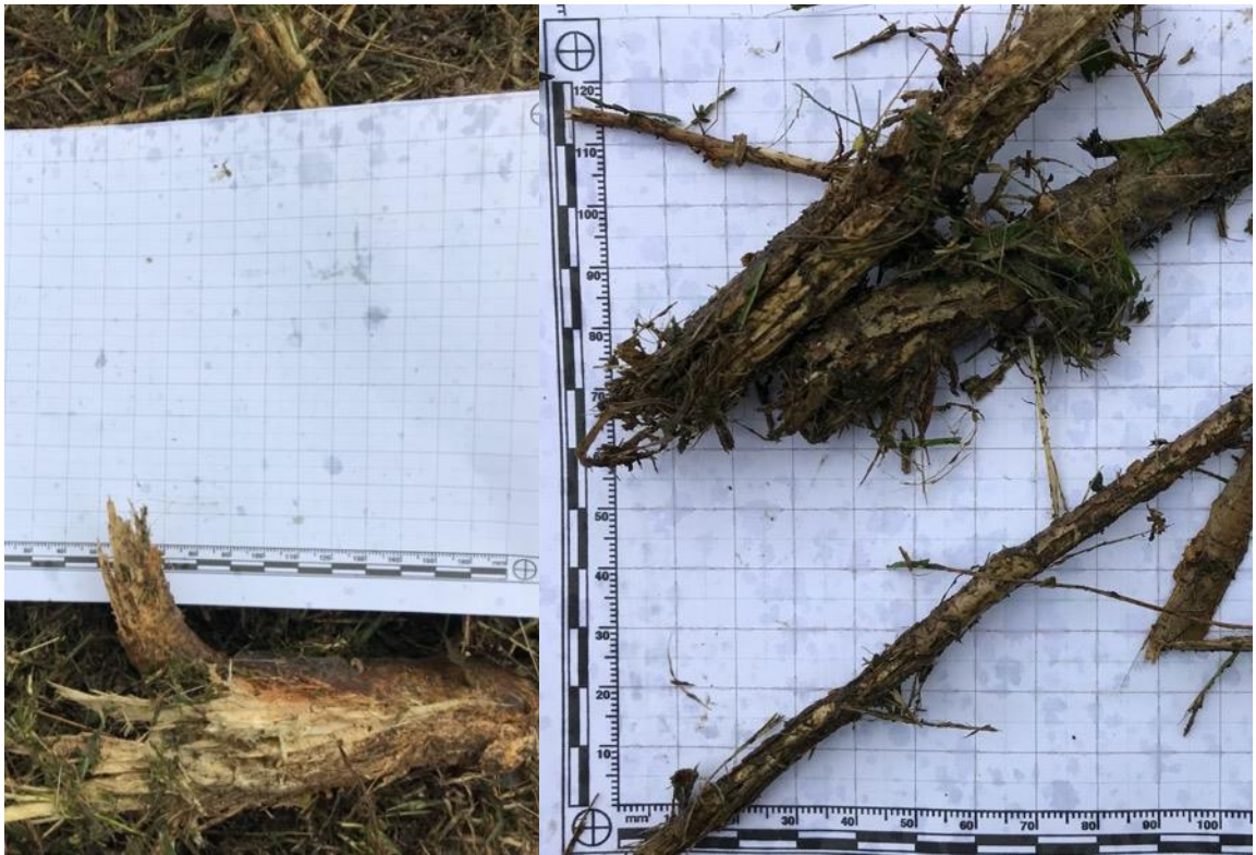
Obrázek 23 Náletová dřevina, průměr 3 cm, posečná cepovým strojem
