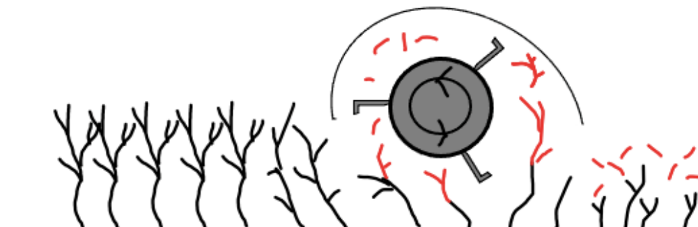
Obrázek 17 Schématické znázornění cepového mulčovacího ústrojí
