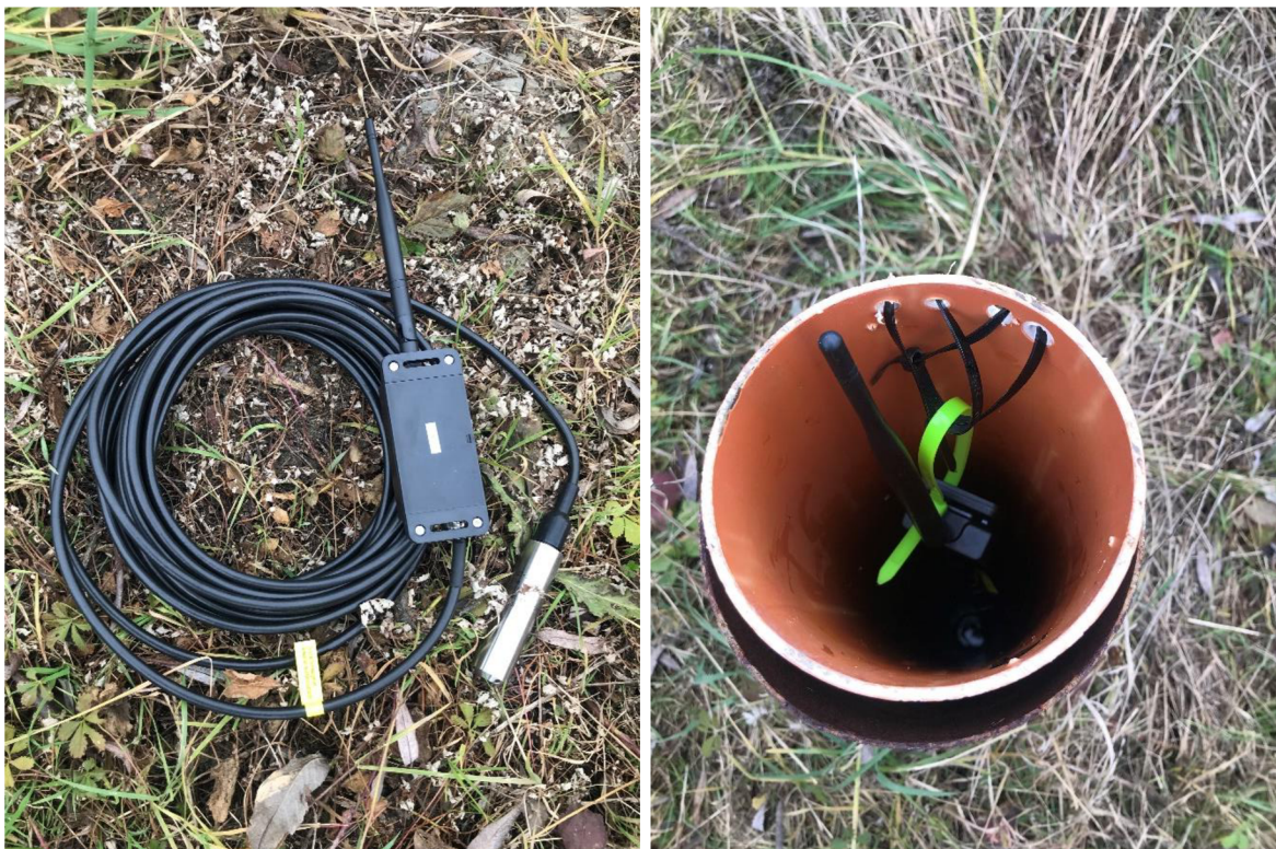
Obr. 4.7 Zařízení dataloggeru s čidlem (vlevo) a umístění zařízení ve výpažnici hydrogeologického vrtu (vpravo)
