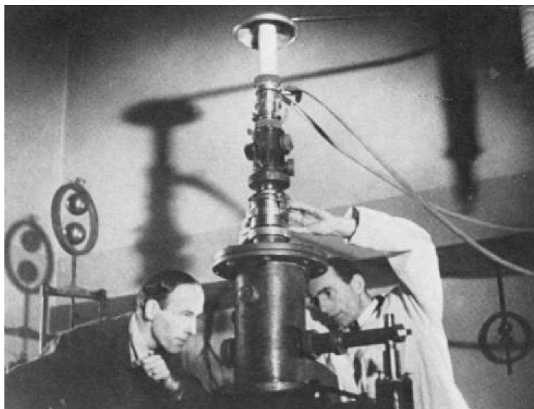
Obrázek 1.1: První transmisní elektronový mikroskop sestrojený v roce 1931 Maxem Knollem (vlevo) a Ernstem Ruskou (vpravo). Obrázek převzat z [12].
