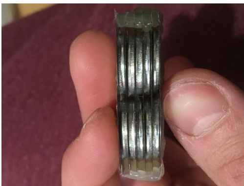
Obrázek 25: Jedna ze soustav žiletek pro testování přilnavosti nátěrů
