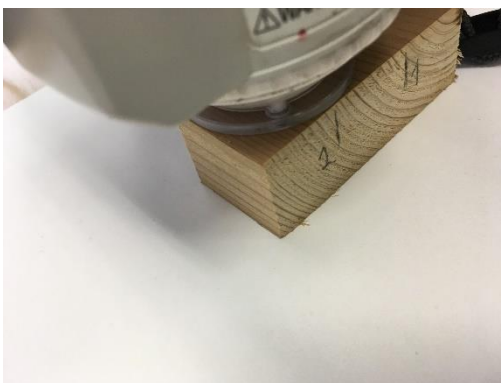
Obrázek 17: Přiložení spektrofotometru ke vzorku
