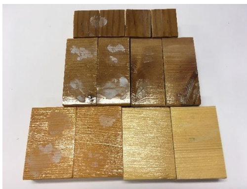
Obrázek 28: Působení vlhkosti na šelakové vzorky (nalevo zestařeno 240 h předem v xenonové komoře, napravo nikoliv)
