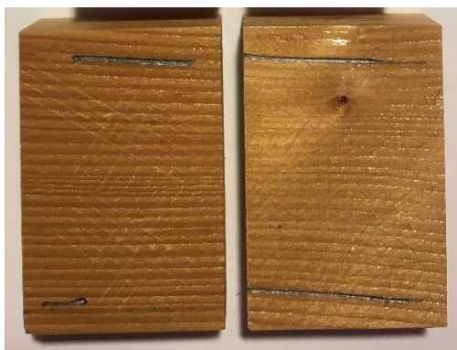
Obrázek 24: Zkoušky přilnavosti a tvrdosti nátěrů na šelakových tělesech z NS
