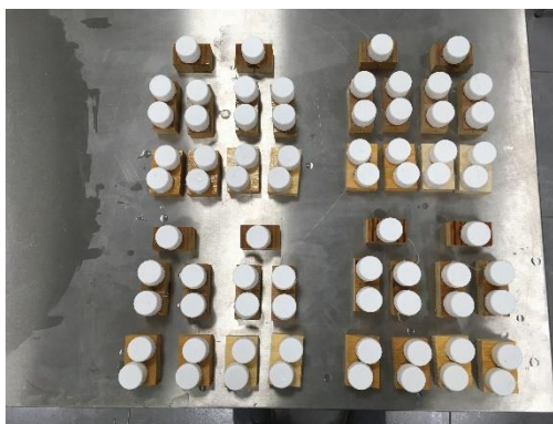
Obrázek 26: Aplikace studené vody na zkušební tělesa
