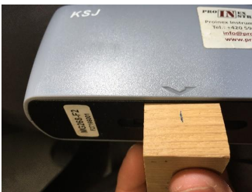
Obrázek 15: Přiložení leskoměru rovnoběžně s vlákny vzorku
