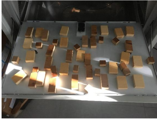
Obrázek 18: Rozložení zkušebních těles před zahájením umělého zetažení v komoře
