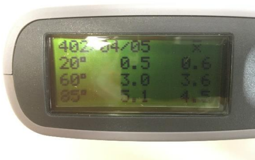
Obrázek 14: Display leskoměru po naměření hodnot
