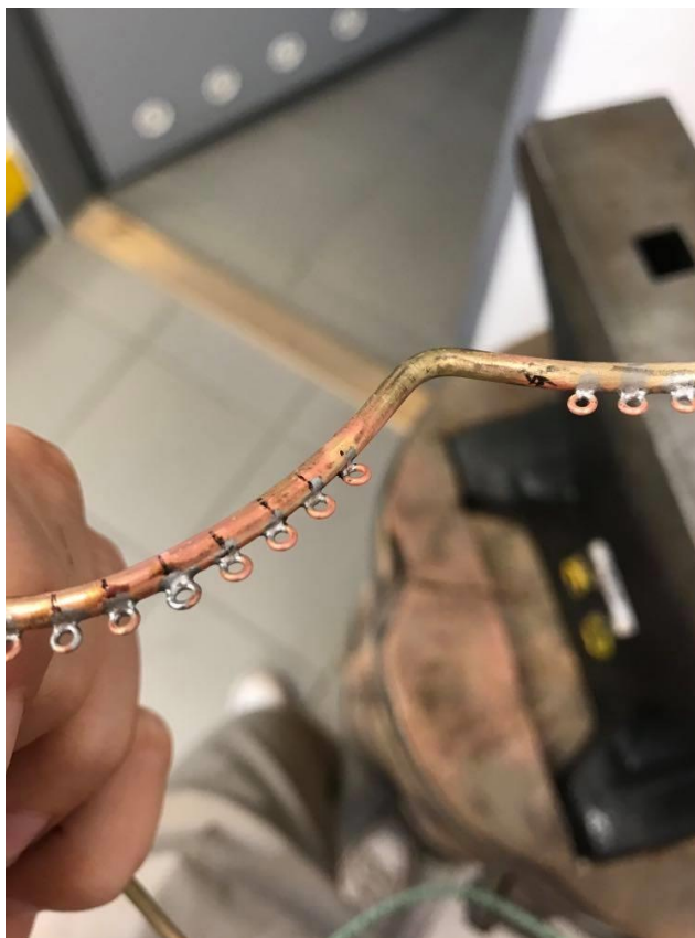
Obr. 26 Detail měkkého pájení kroužků
