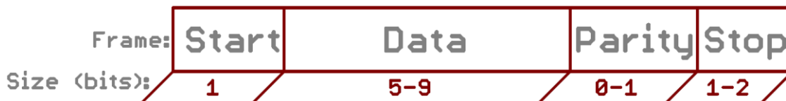
Obrázek 17: Příklad komunikace pomocí sběrnice RS232 [10]
