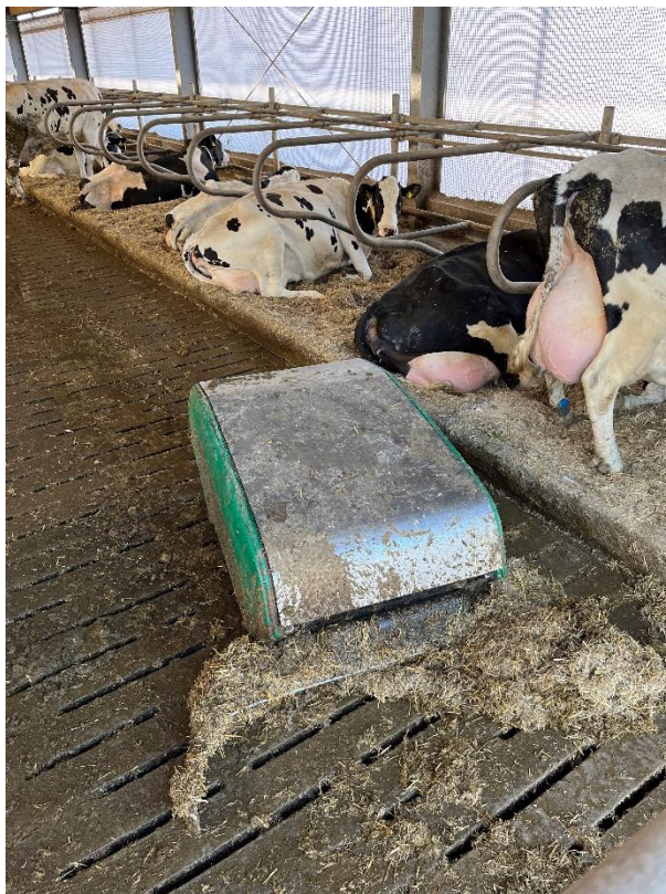
Obr. P. 19 Robot na úklid roštů
