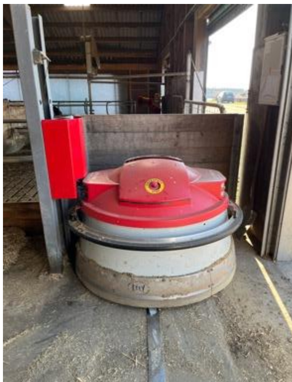
Obr. 18 Robotický přihrnovač Juno 150
