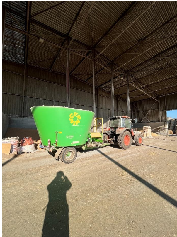
Obr. P. 27 Vertikální krmný vůz
