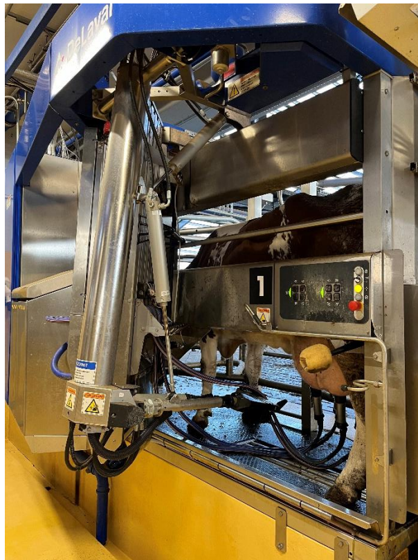
Obr. P. 11 Dojící robot
