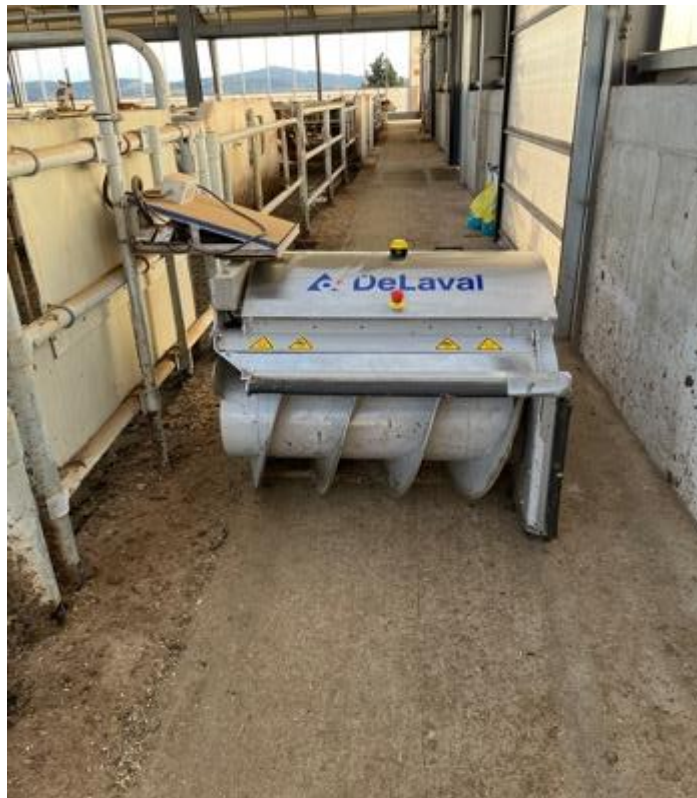
Obr. 17 Robotický přihrnovač OptiDuo
