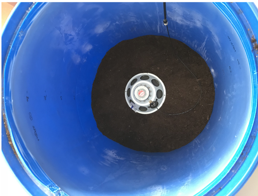
Obr. 5.4: Plastový sud se zeminou a reproduktorem
