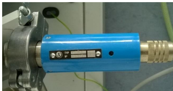
Obrázek 22: Měrka vakuometru Pirani VPR 1 (LAVAT).
