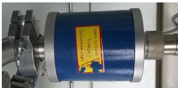
Obrázek 24: Měrka vakuometru Penning VPG 1 (LAVAT).
