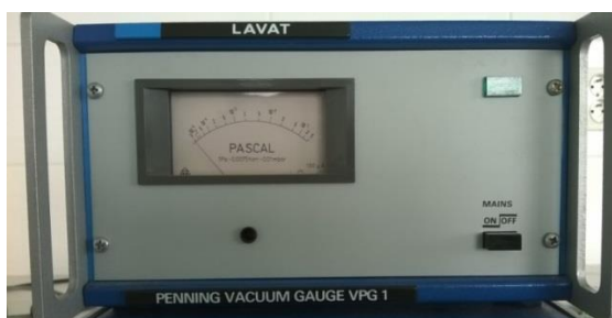
Obrázek 23: Zdroj pro vakuometr Penning VPG 1 (LAVAT).
