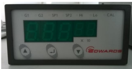
Obrázek 25: Zdroj pro vakuometr Penning AIM-S-NW25 (Edwards).
