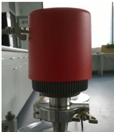
Obrázek 26: Měrka vakuometru Penning AIM-S-NW25 (Edwards).
