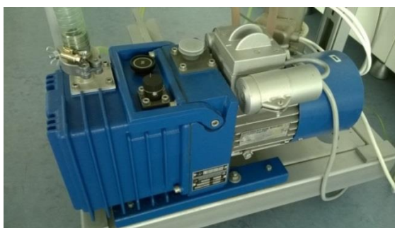
Obrázek 20: Olejová rotační vývěva VRO 05/21 (LAVAT).
