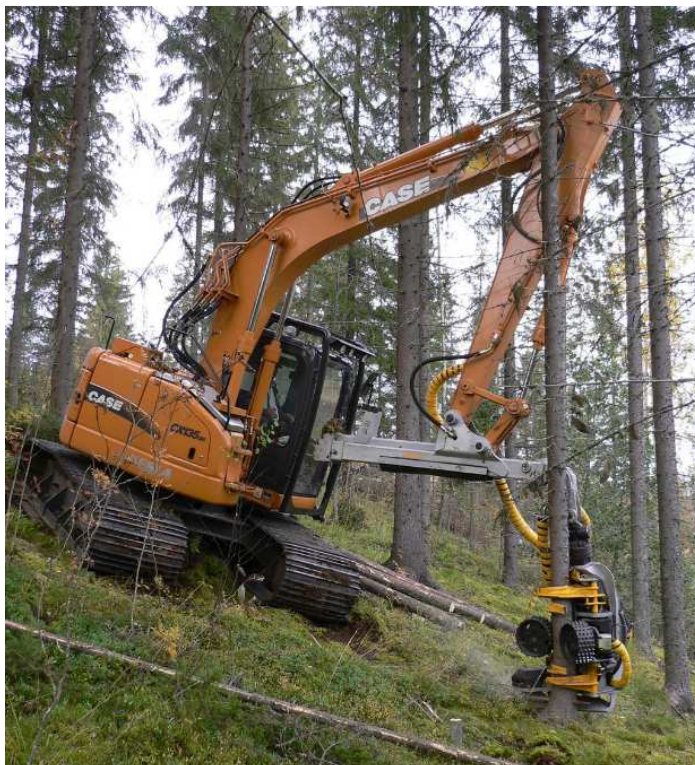
Obr. 7 Pásové rypadlo CASE CX 135 SR opatřené harvestorovou hlavicí ( http://www.flickr.com/groups )
