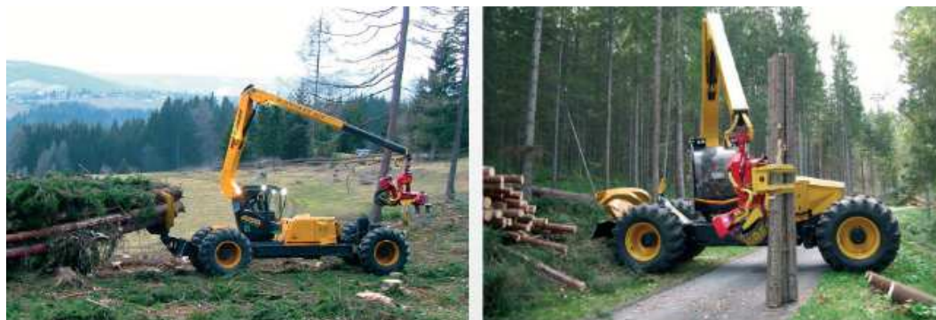
Obr. 3 Vyvezení celých stromů za pomoci Highlanderu a následné zpracování na lesní cestě ( www.krenn.sk/highlander.html )
