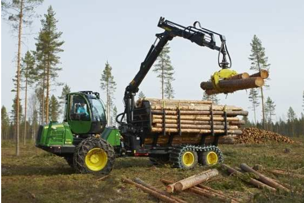
Příloha č. 5 Současný vyvážecí traktor John Deere 1010E s kabinou otočnou o 360° ( www.merimex.cz )
