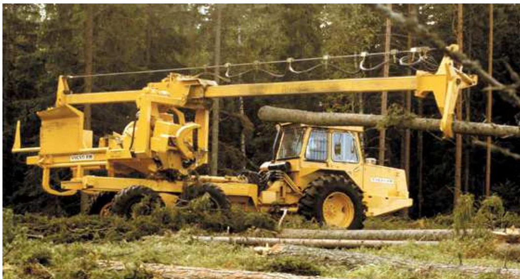
Příloha č. 8 Procesor Volvo BM 980 s teleskopickým ramenem, vyráběný v letech 1973-1977 (www.volvoce.com/constructionequipment)
