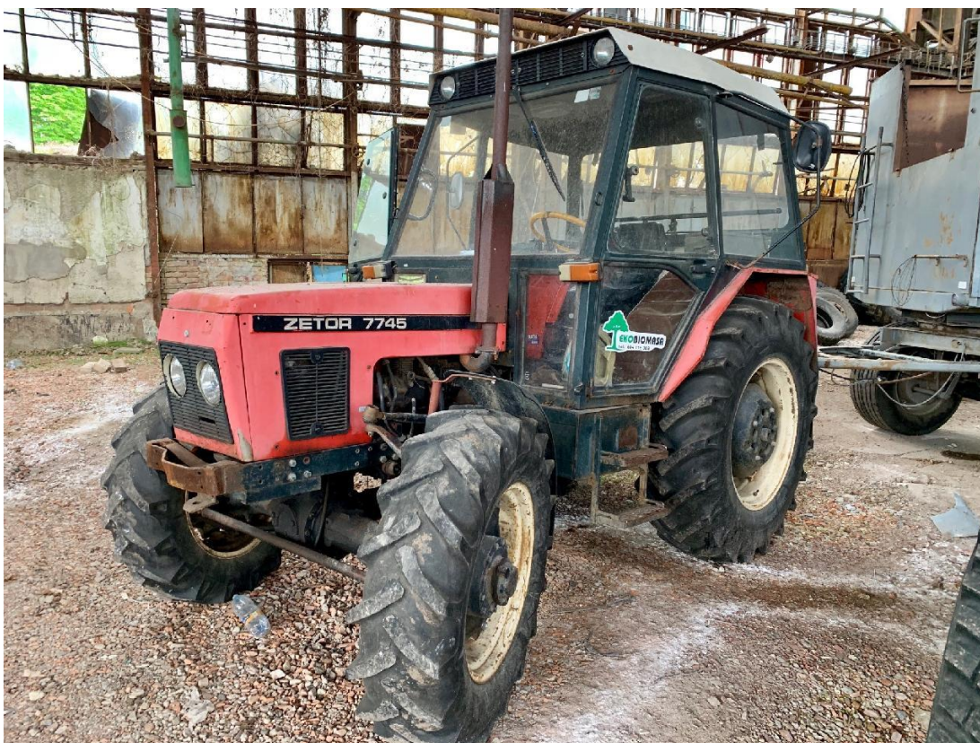
Obrázek 4.3: Špatná montáž předních pneumatik (Drazby.cz, 2022)
