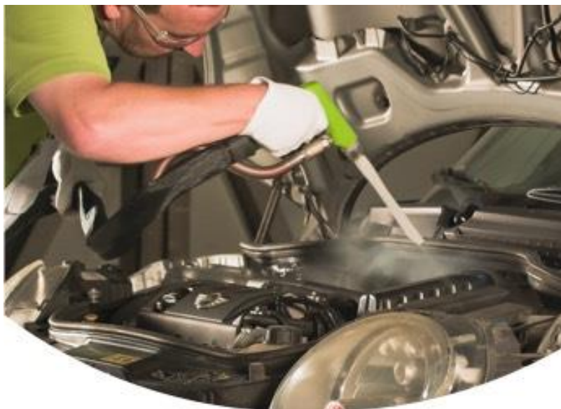
Obrázek 1.1: Čištění motoru suchým ledem (Doktor-dulek.cz, 2022)
