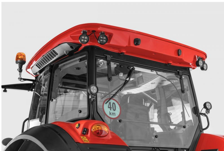
Obrázek 4.2: Označení nejvyšší konstrukční rychlosti (Nn-kosatky.cz, 2022)
