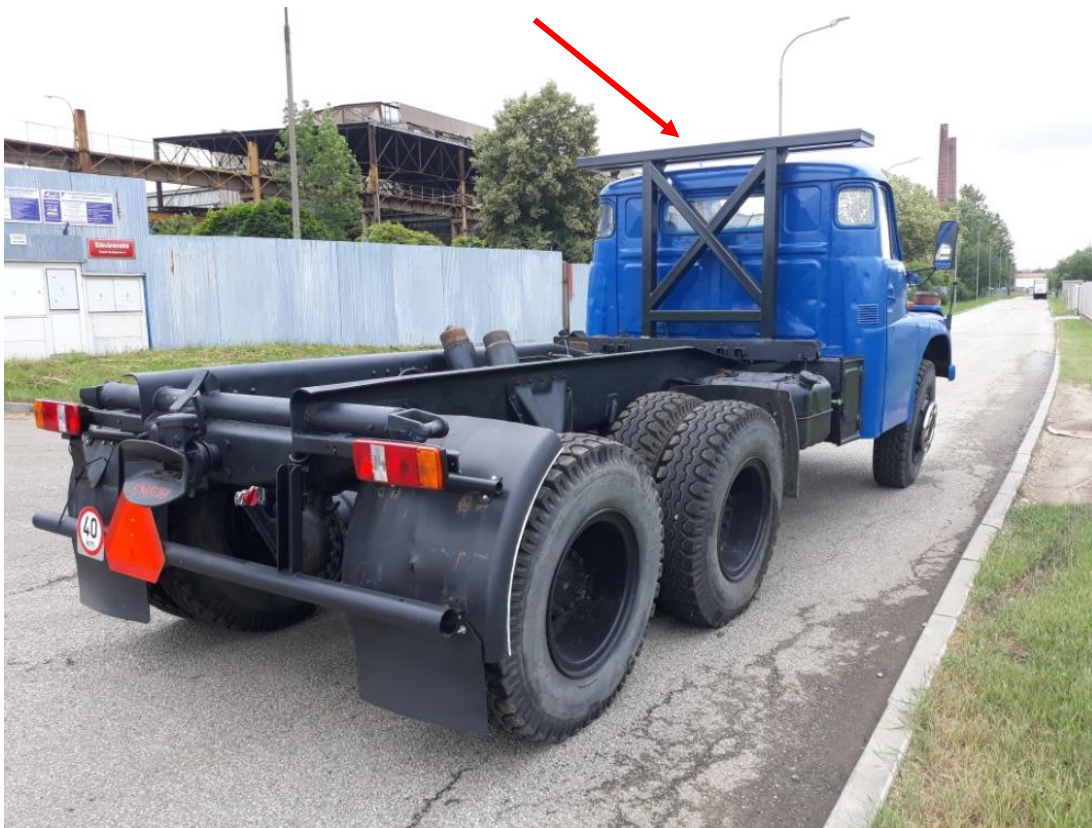
Obrázek 5.2: Umístění ochranného rámu (Ramatservis.cz, 2022)
