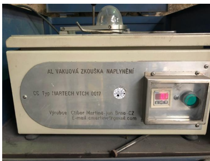
Obrázek 40: Měření Dichte indexu při experimentu
