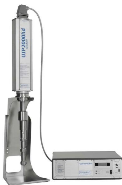
Obrázek 24: Ultrazvukové zařízení pro odplynění taveniny [24]
