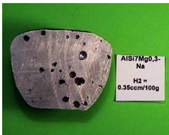
Obrázek 25: Vzorek pro vyhodnocení zkoušky Straube-Pfeiffer [26]
