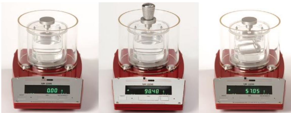
Obrázek 30: Vážení vzorku pro stanovení Dichte indexu [26]
