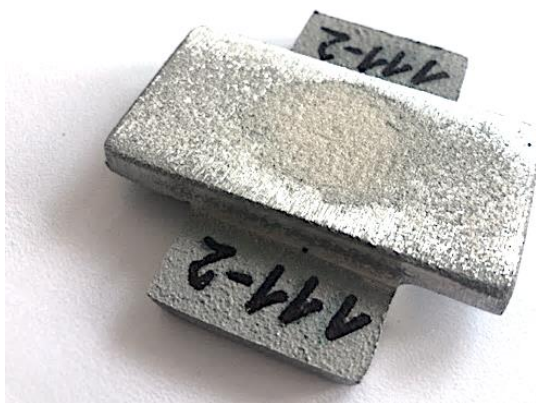
Obrázek 45: Měření objemu vnější staženiny
