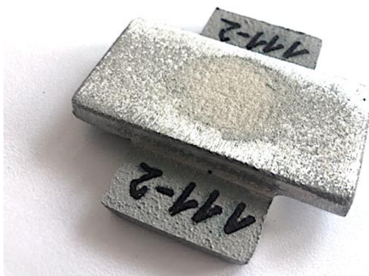
Obrázek 45: Měření objemu vnější staženiny
