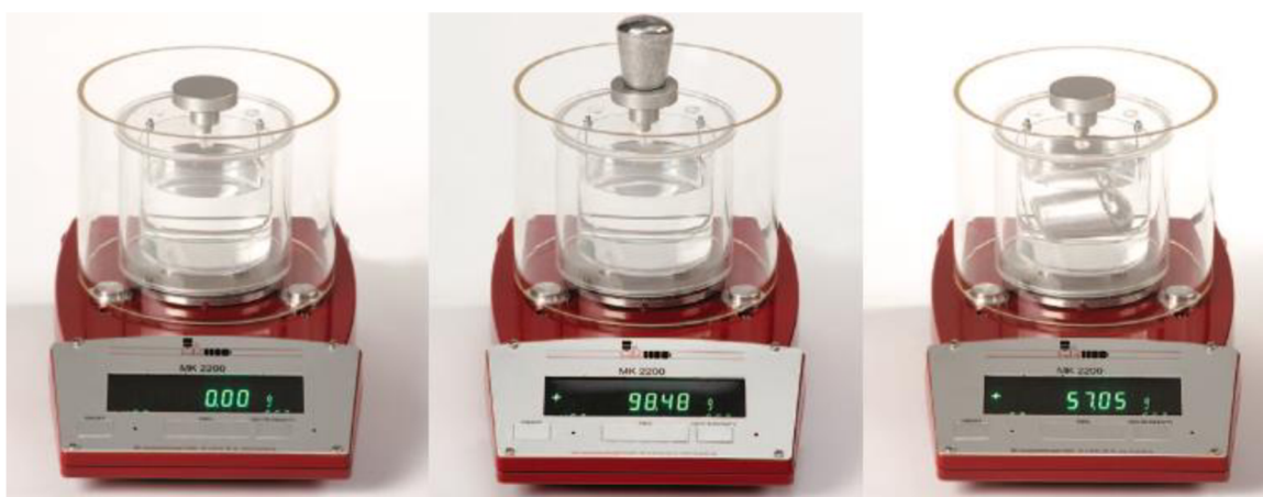
Obrázek 30: Vážení vzorku pro stanovení Dichte indexu [26]
