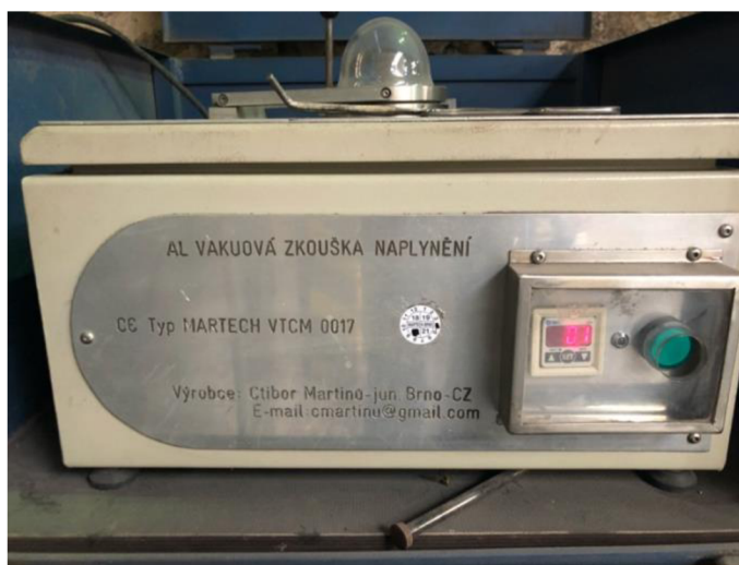
Obrázek 40: Měření Dichte indexu při experimentu
