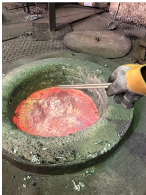
Obrázek 37: Aplikace Probat Fluss Mikro 100
