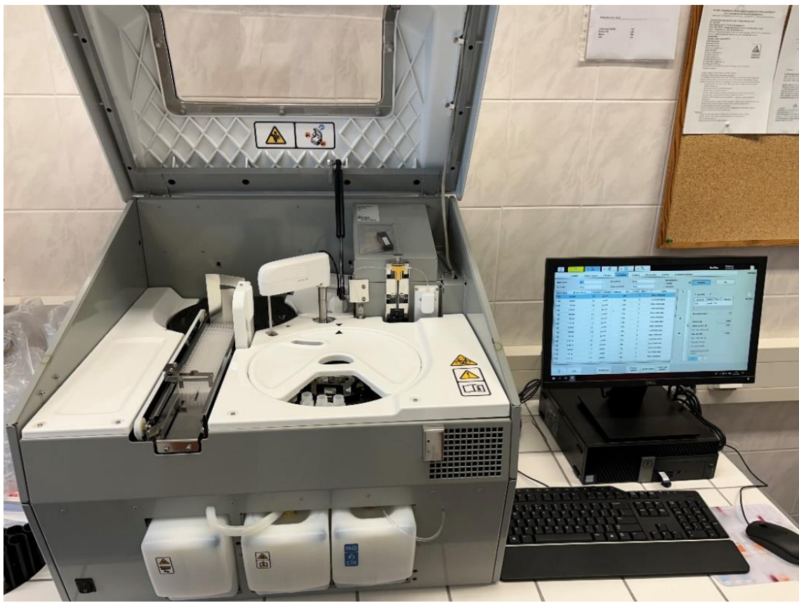
Obrázek 5 – otevřený analyzátor Thermo Scientific Indiko (zdroj: vlastní)
