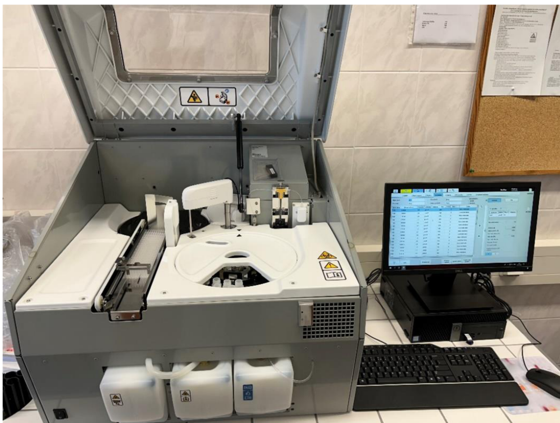
Obrázek 5 – otevřený analyzátor Thermo Scientific Indiko (zdroj: vlastní)
