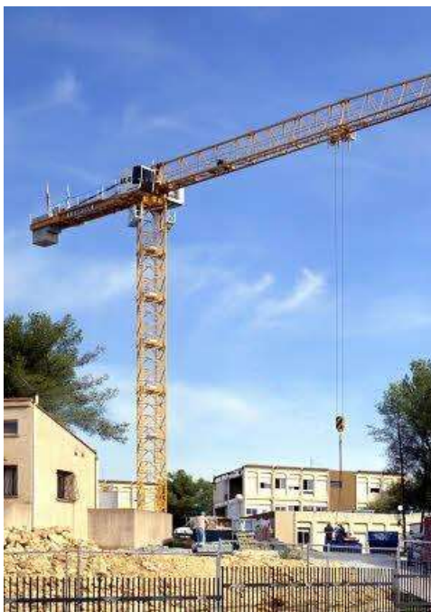
Obrázek 49-Věžový jeřáb Liebherr 250 EC-B 12 litronic
