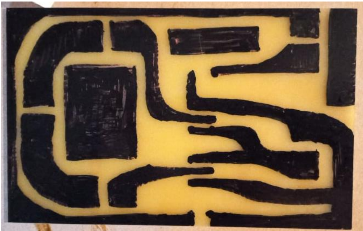
Obrázek 18: Výsledek po vyleptání DPS chloridem železitým
