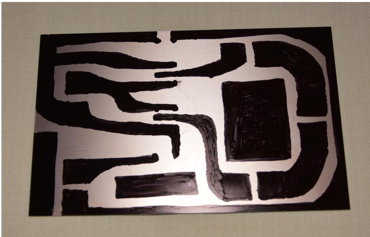
Obrázek 16: Schéma zakreslené na desce plošných spojů
