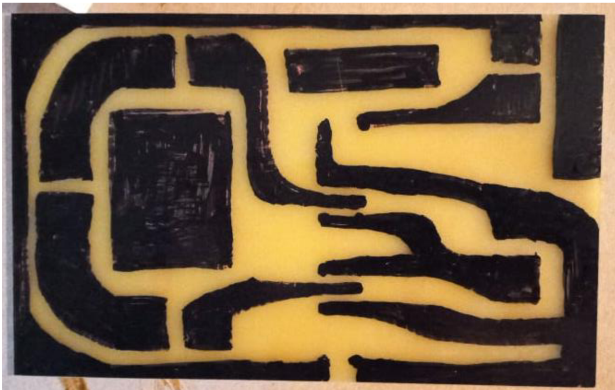
Obrázek 18: Výsledek po vyleptání DPS chloridem železitým
