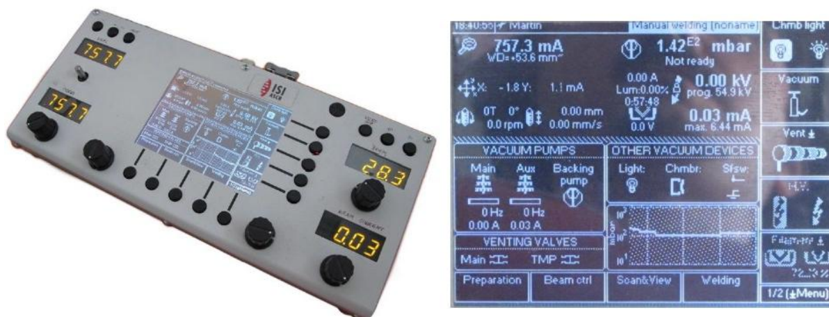
Obr. 6.12 Ovládací panel svářečky EMBW 60/2 a grafický displej [6].
