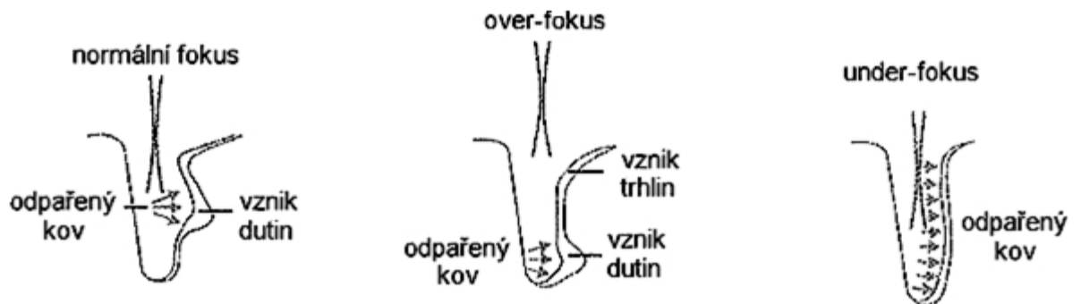
Obr. 3.13 Vliv zaostření svazku na tvorbu dutin [11].
