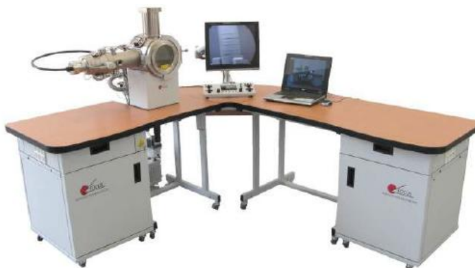
Obr. 6.1 Elektronová svářečka MEBW 60/2 [7].
