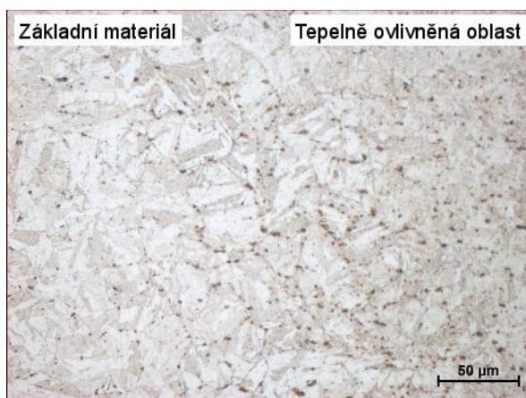
Obr. 7.37b) Přechod mezi ZM a TOO - 500x.
