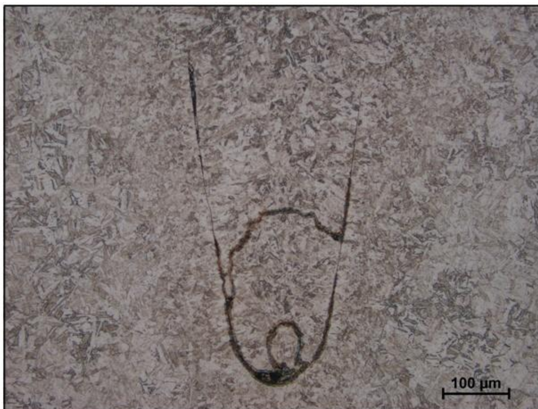
Obr. 7.7 Defekty v kořeni průvaru, zaostření svazku nad povrch vzorku, v_s = 10 \text{ mm} \cdot \text{s}^{-1} .
