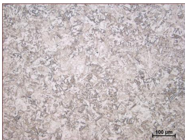
Obr. 7.34a) Základní materiál - 200x.
