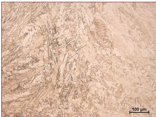
Obr. 7.41a) Svarový kov - 200x.
