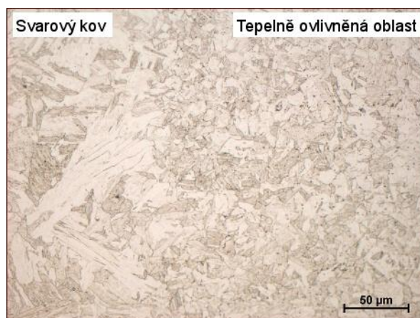
Obr. 7.38b) Přechod mezi SK a TOO - 500x.
