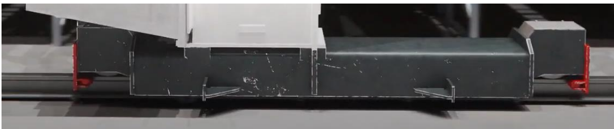
Obr. 3.3 Pojezdová jednotka jednosloupového regálového zakladače [9]
