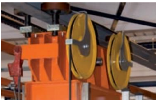
Obr. 3.4 Horní vodící základna jednosloupového regálového zakladače [7]
