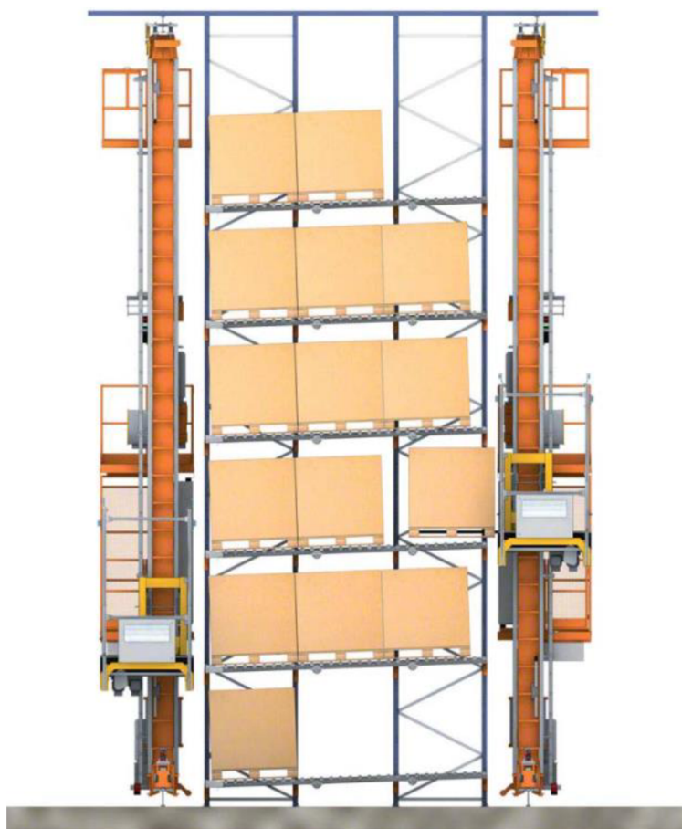
Obr. 2.1 Regálové zakladače obsluhující spádové regály [1]
