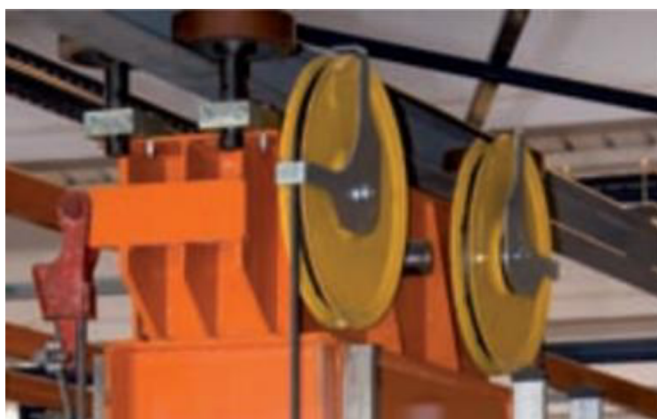
Obr. 3.4 Horní vodící základna jednosloupového regálového zakladače [7]
