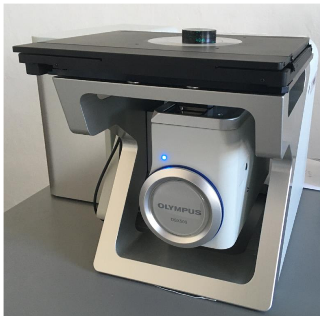
Obr. 4.5 Mikroskop Olympus DSX 500.
