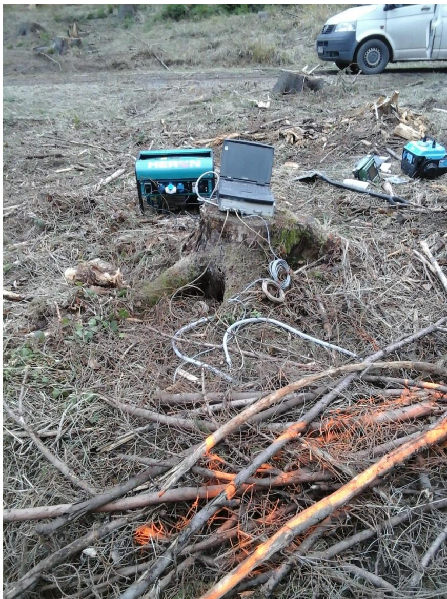
Obr. 25 Měřicí aparatura před měřením tlaků pod 30 cm klestu (Michal Mutina)
