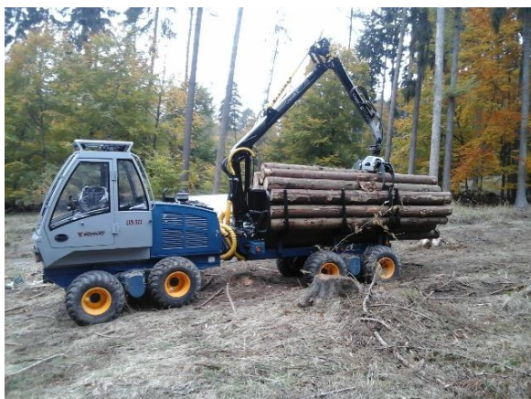
Obr. 22 Zatížený vyvážecí traktor s maximální nosností 5 t (Michal Mutina)
