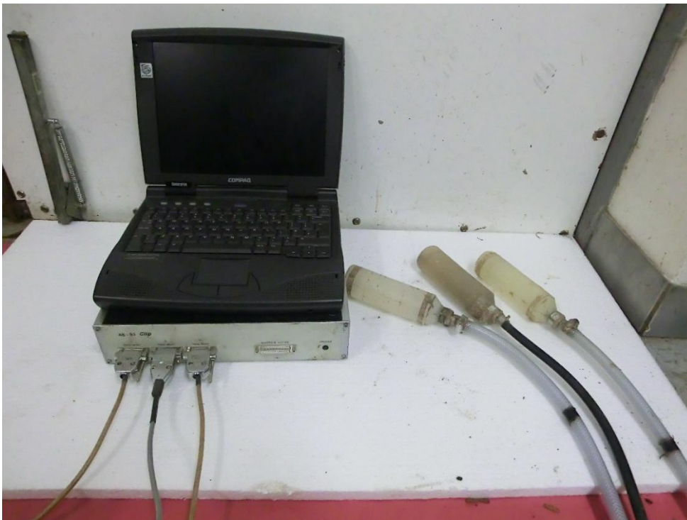
Obr. 10 Tlakoměr se třemi tlakovými sondami (Michal Mutina)
