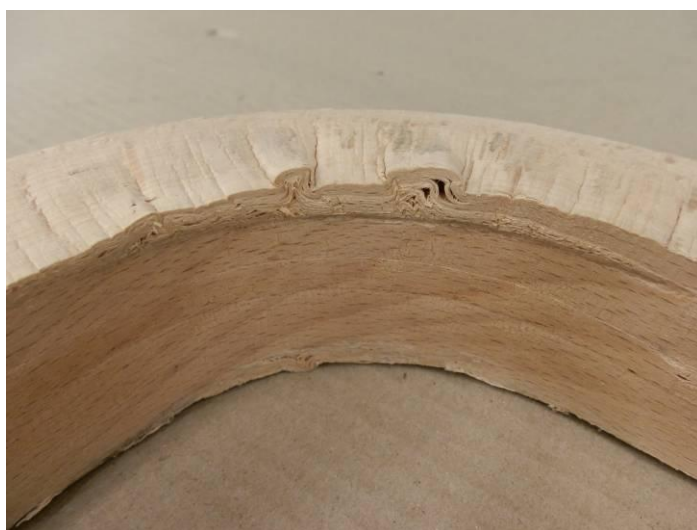
Obr. 20 Záhyby na vnitřní straně ohybu
