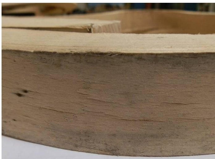
Obr. 15 Jemné podélné porušení vláken na konvexní ploše
