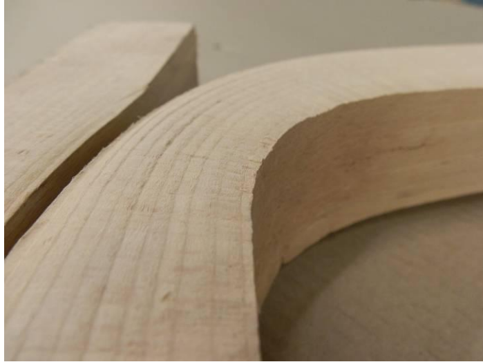
Nerovnoměrně stlačené letokruhy vlivem rozdílné hustoty jarního a letního dřeva
