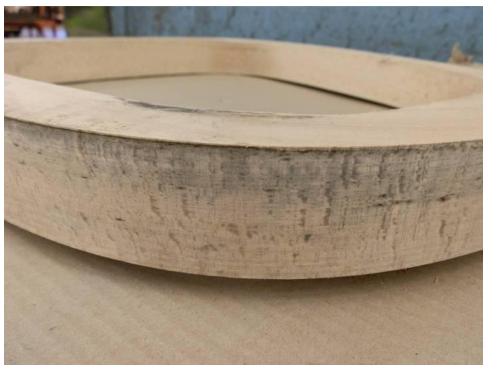
Zbarvení ohybu od nové pásnice
