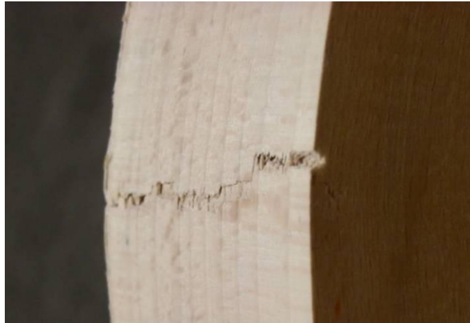
Obr. 16 Porušení vláken v příčném směru
