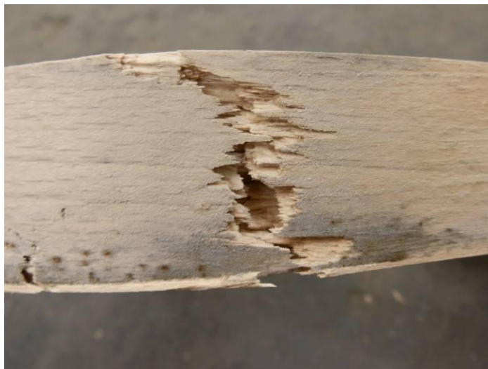
Obr. 17 Porušení vláken v příčném směru
