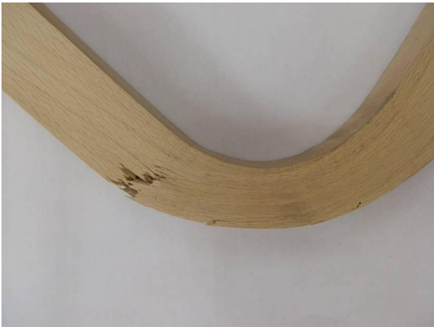
Příčné porušení dřevních vláken (lom)
