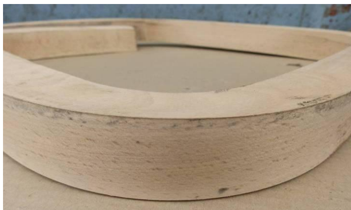
Obr. 14 Ohyb bez vad - detail konvexní plochy
