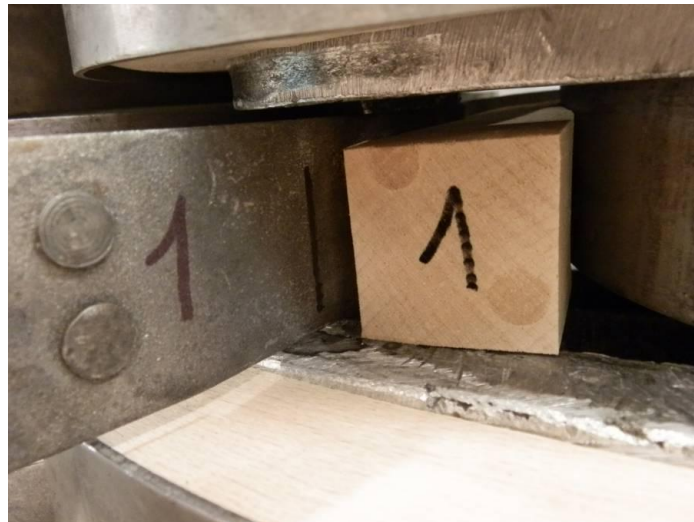
Obr. 12 Značení stopy roviny čelní plochy hranolku
