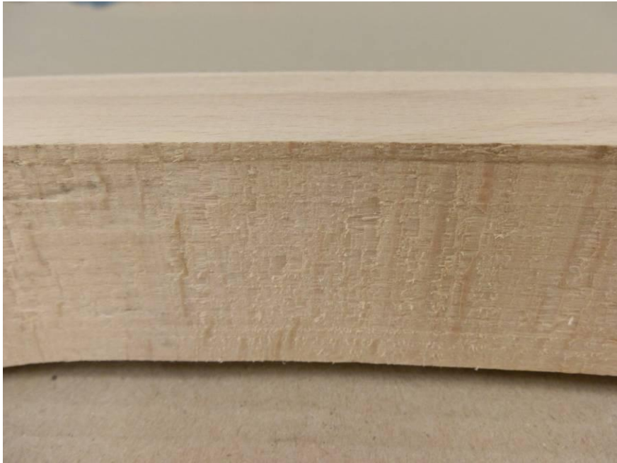
Vytrhaná zrcátka (dřeňové paprsky) vlivem nekvalitního opracování povrchu
