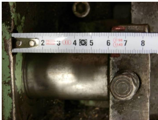
Obr. 11 Měření pístu po ohýbání
