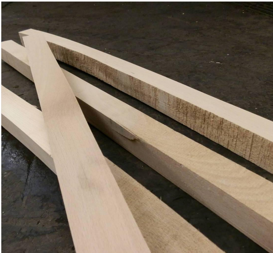
Vytříděné hranolky před operací plastifikace (odklon vláken, kvalita opracování)
