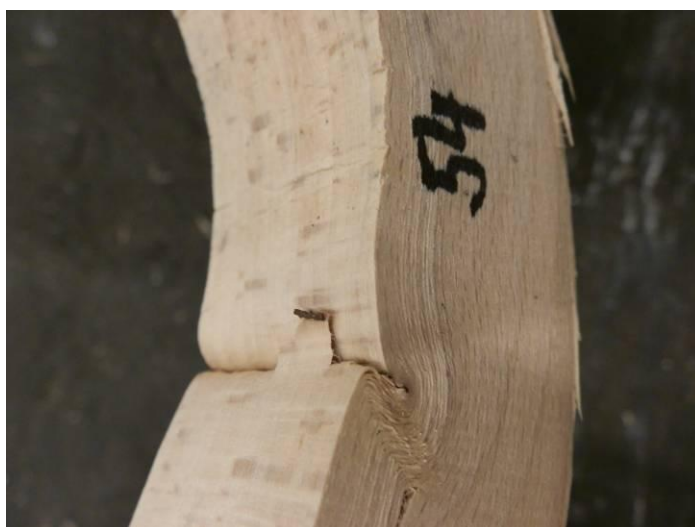
Vliv přítomnosti svalu ve dřevě během ohýbání
