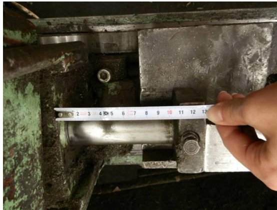
Obr. 10 Měření pístu před ohýbáním
