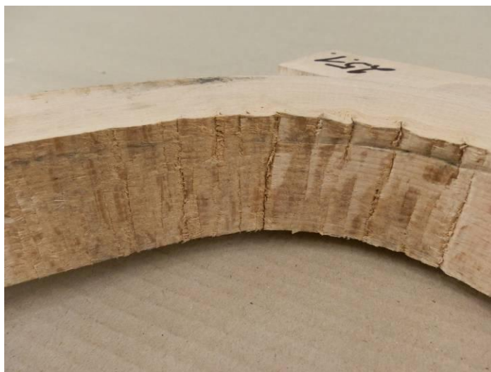
Vliv drsnosti opracování na kvalitu ohybu
