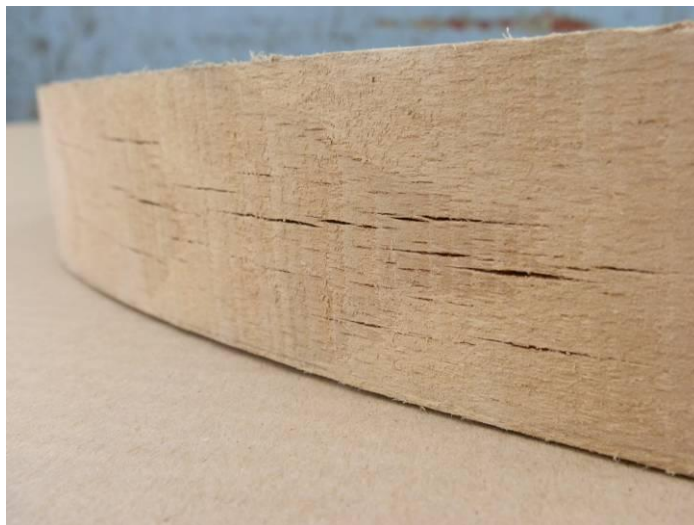
Obr. 18 Trhlina na ploše
