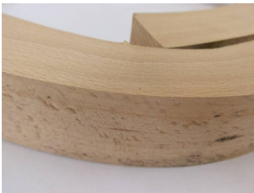
Ukázka správného uložení dřevěných paprsků k rovině ohybu
