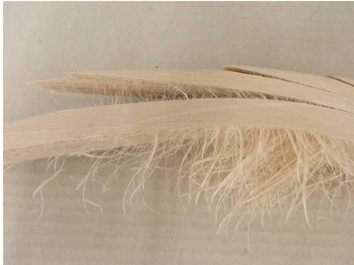
Vytržení vláken při porušení pásnice v průběhu ohybu
