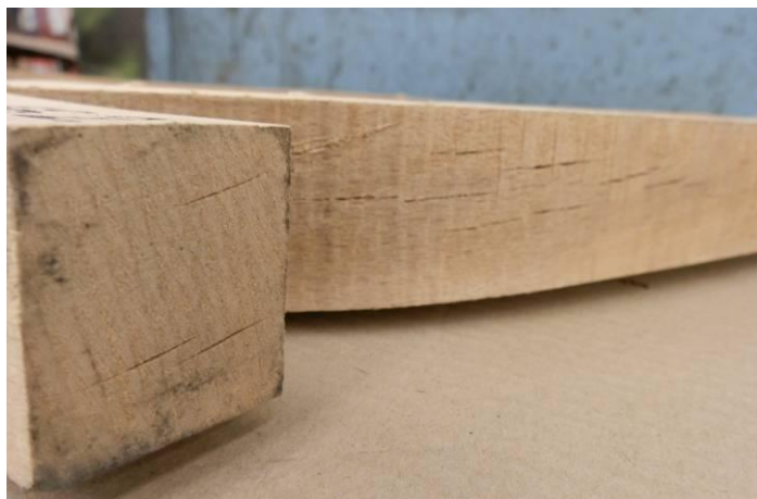
Obr. 19 Trhliny na čele hranolku
