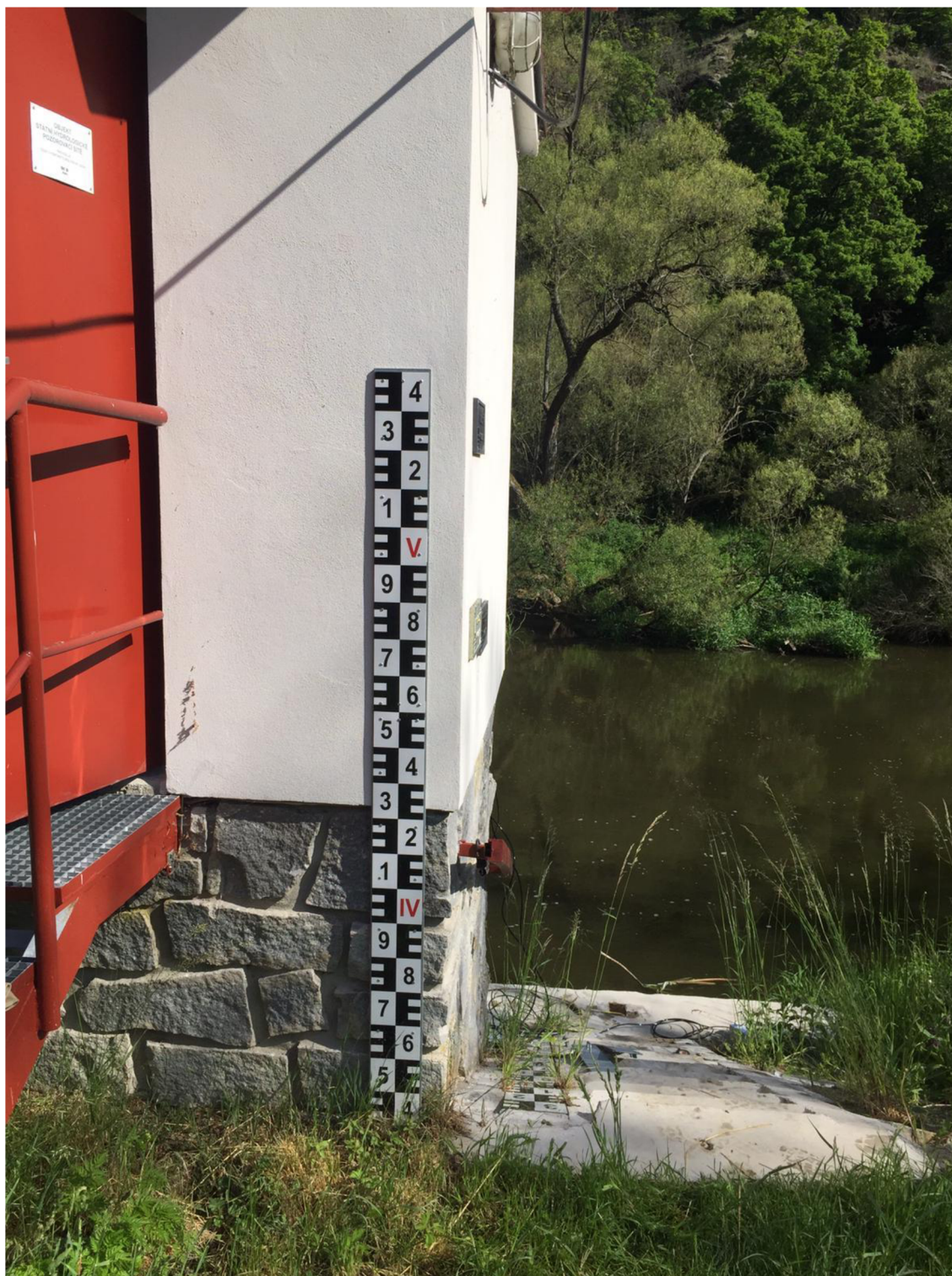
Obr. 21 Měření hladiny nad 4 metry výšky
