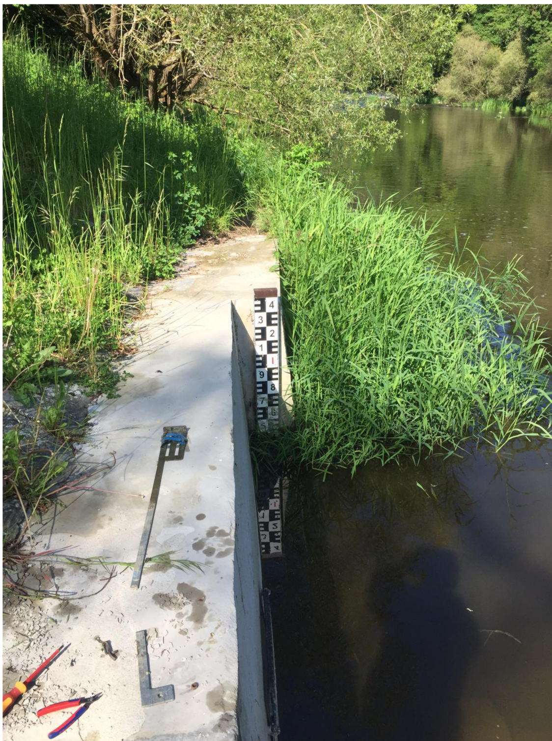
Obr. 24 Měření hladiny okolo 1 metru výšky
