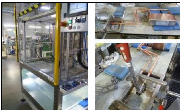
Obrázok 23: Skúška únikov PHE (Zdroj: Vlastné spracovanie)
