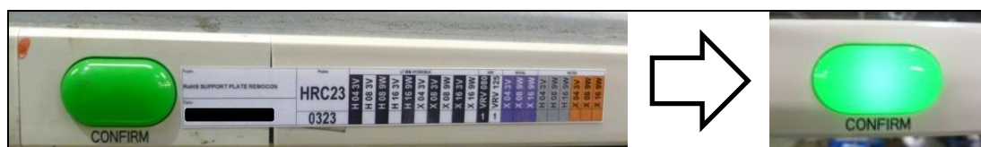
Obrázok 20: Pick-to-light systém (Zdroj: Vlastné spracovanie)
