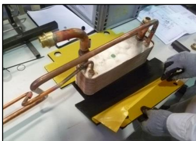
Obrázok 24: Izolácia PHE (Zdroj: Vlastné spracovanie)
